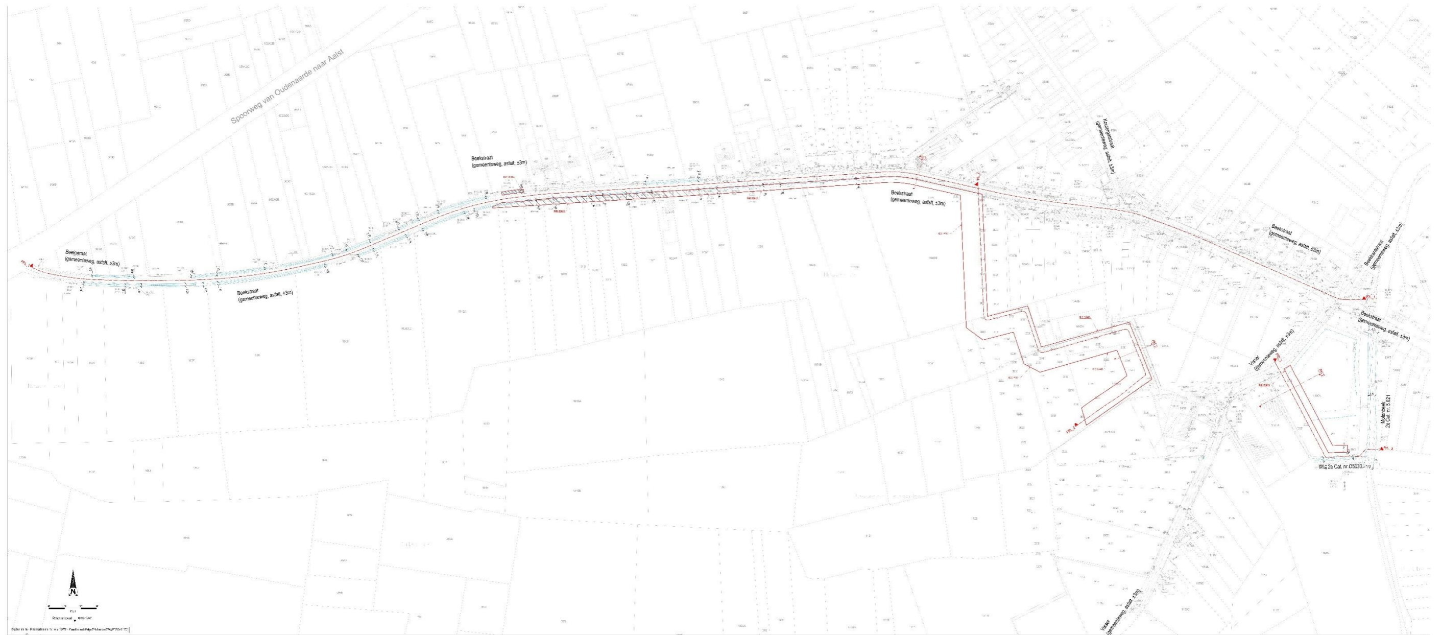
Figuur 22. Bestaande toestand riolering.
