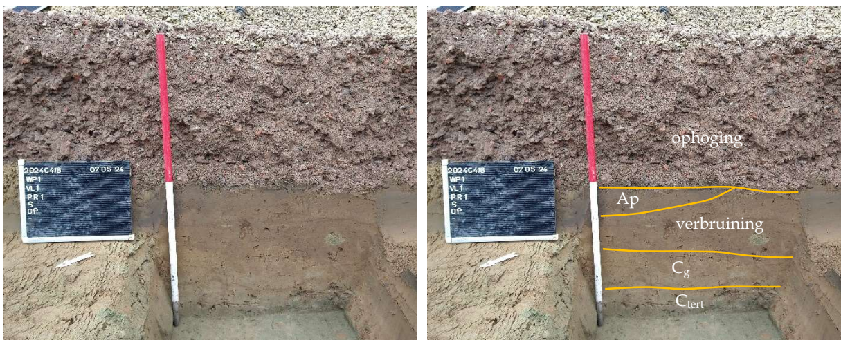
Figuur 14. Referentieprofiel P1, werkput 1. ©LARES
