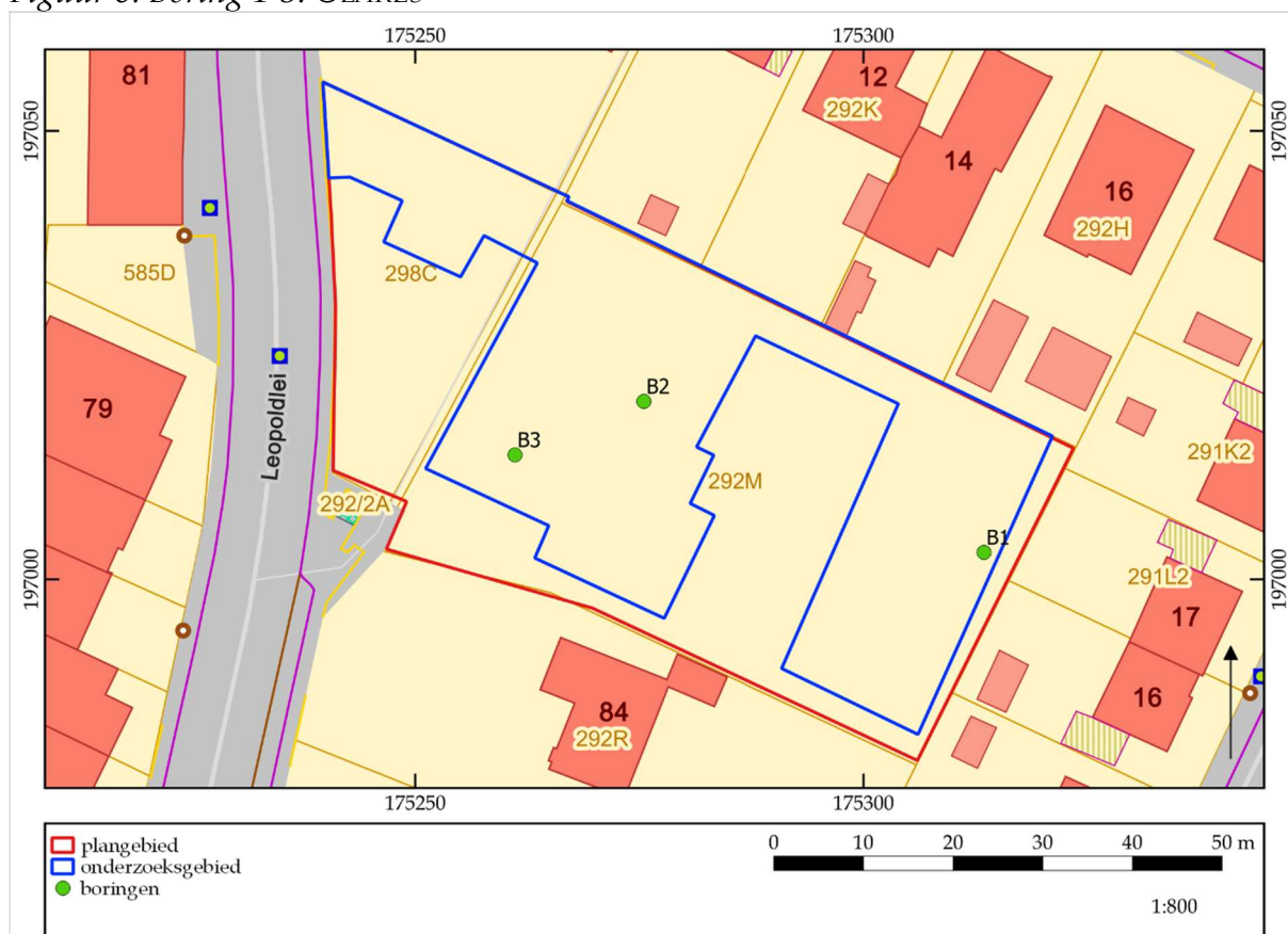
Figuur 9. Ligging van de uitgevoerde boringen. ©LARES
