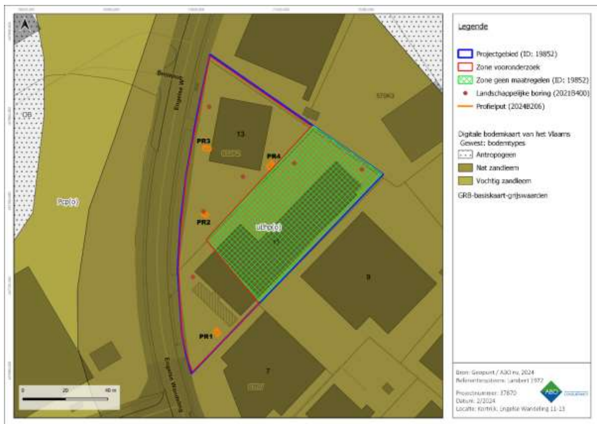
Figuur 9: Aangelegde profielputten (2024B206) t.o.v. uitgevoerde boringen (2021B400) in het kader van de archeologienota ID: 19852, geplot op de bodemkaart met het GRB als basis.
