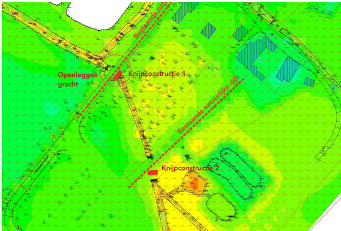
Fig. 1.12: Aanduiding van de dijken en de locaties van de te plaatsen damwanden (© Initiatiefnemer).
