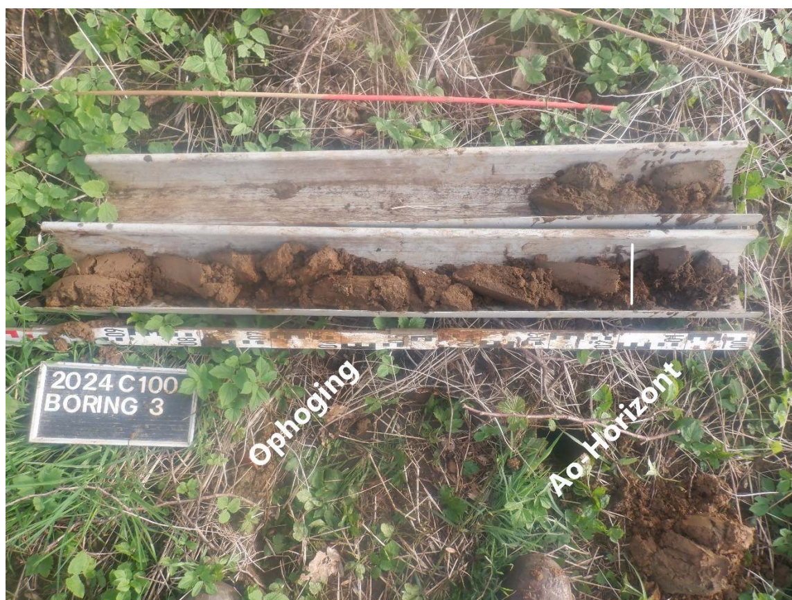
Afbeelding 8.6 Boring 3 met aanduiding van de verschillende horizonen.
