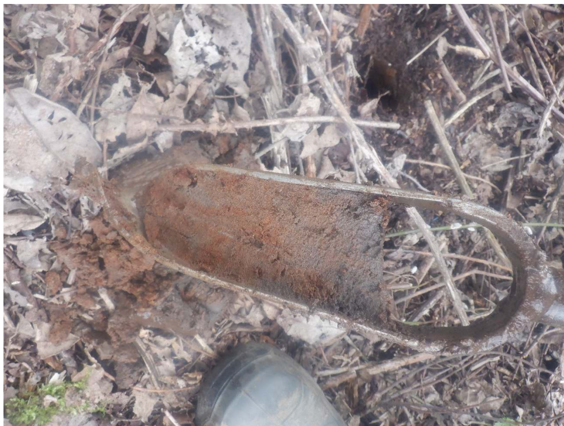
Afbeelding 8.2: Detail van de sterk gegleyificeerde C1-horizont in boring 1.
