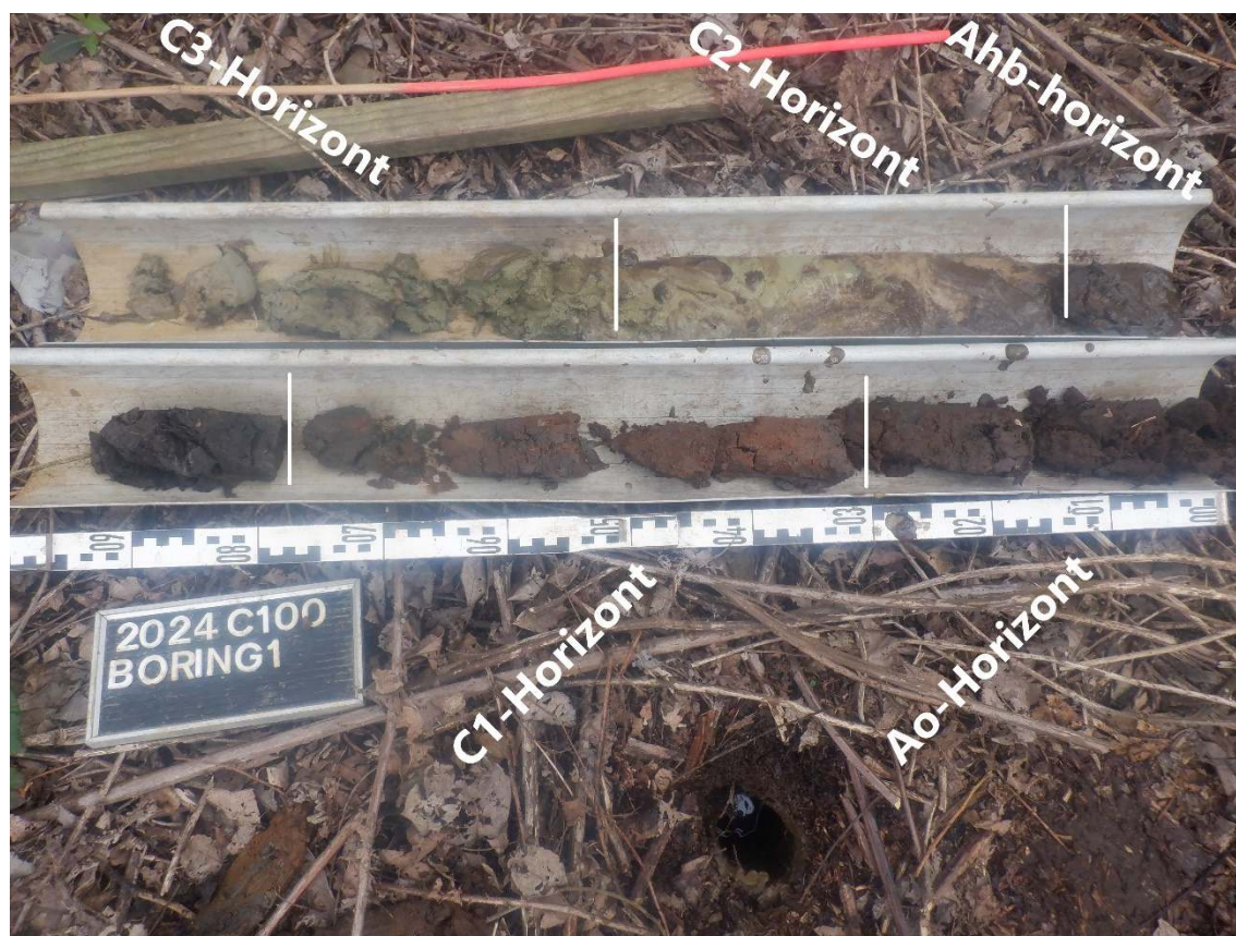
Afbeelding 8.5: Boring 1 met aanduiding van de verschillende horizonen.
