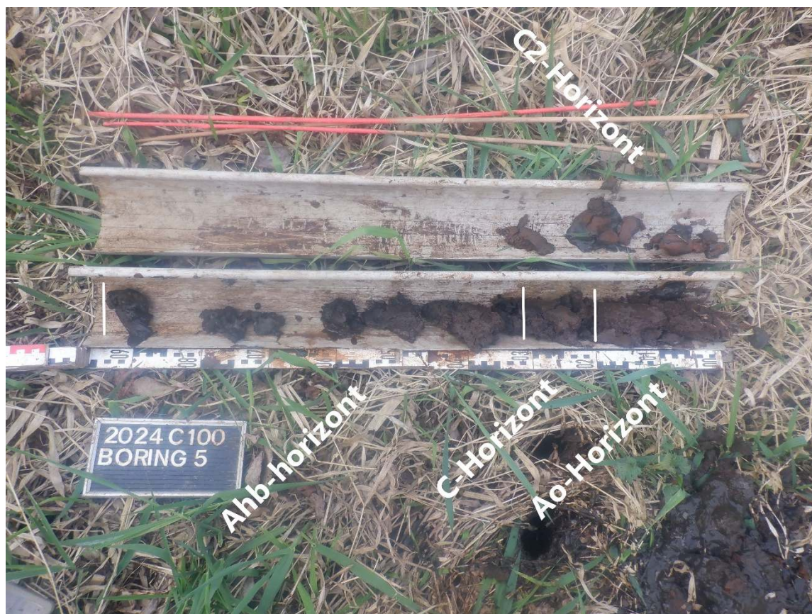
Afbeelding 8.7: Boring 5 met aanduiding van de verschillende horizonten.
