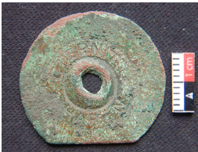
Figuur 45. Koperen sluitschelp voor golfplaten.
