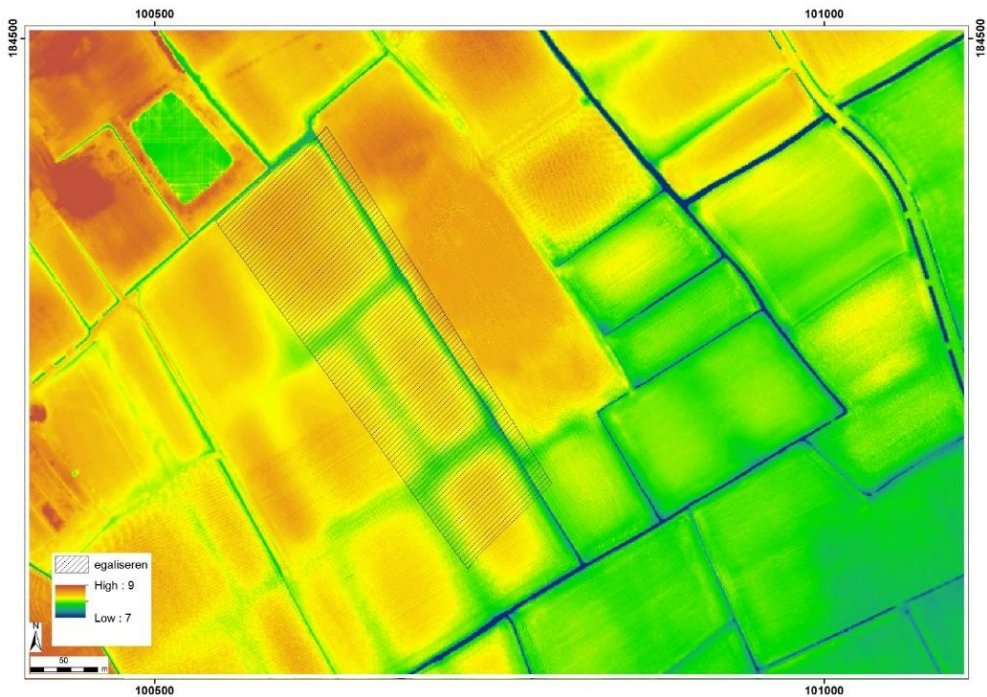
58 Situering van de te egaliseren percelen na demping bestaande kavelgrachten op het DTM © AIV+VLM.
