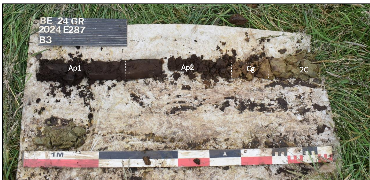
Afb. 15: Referentieprofiel B3 met aanduiding van de horizonten.
