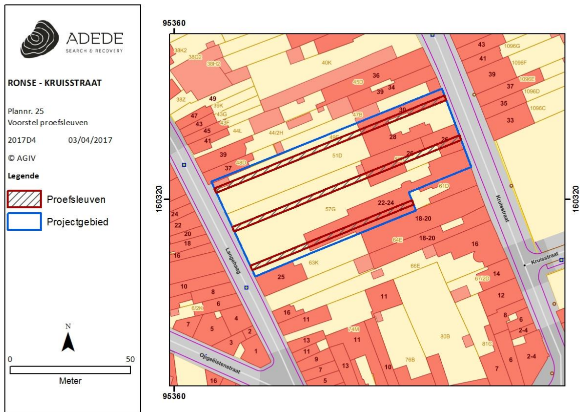
Figuur 3. Voorstel proefsleuven
