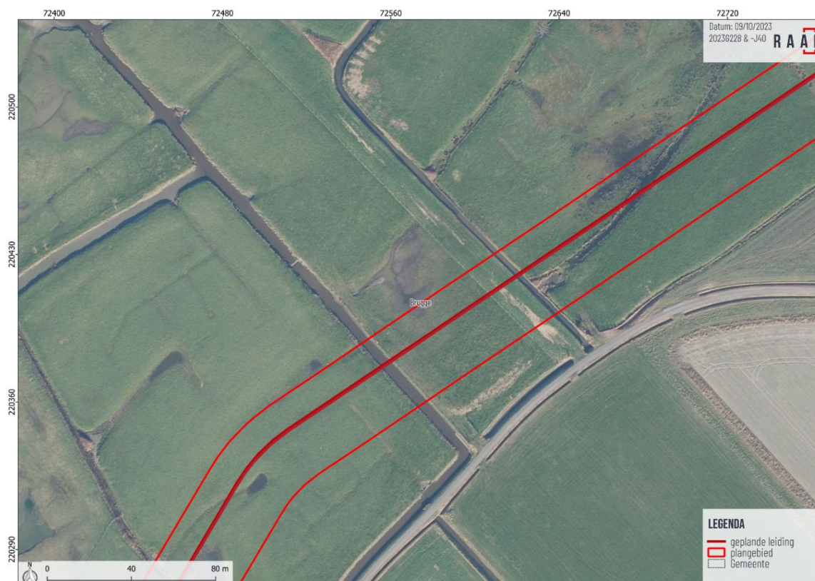
Figuur 15. Een voorbeeld van enkele brede sloten nabij Dudzele, weergegeven op een luchtfoto (bron: AGIV, 2019). Bij dergelijke sloten kan de aannemer beslissen om de waterweg af te dammen en veranderd dus de impact van de werken door een andere werfinrichting.
