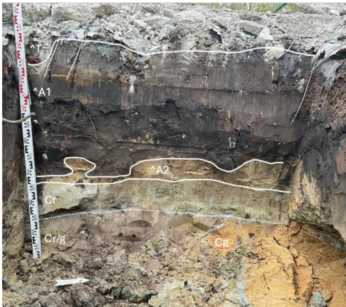
Figuur 10: Westprofiel van profielput PP1.
