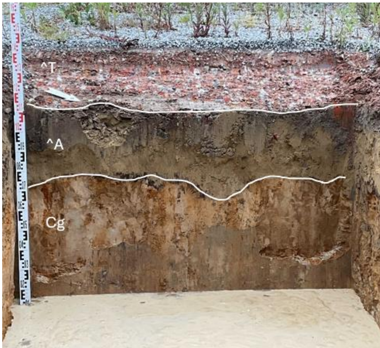
Figuur 14: Westprofiel van profielput PP5.
