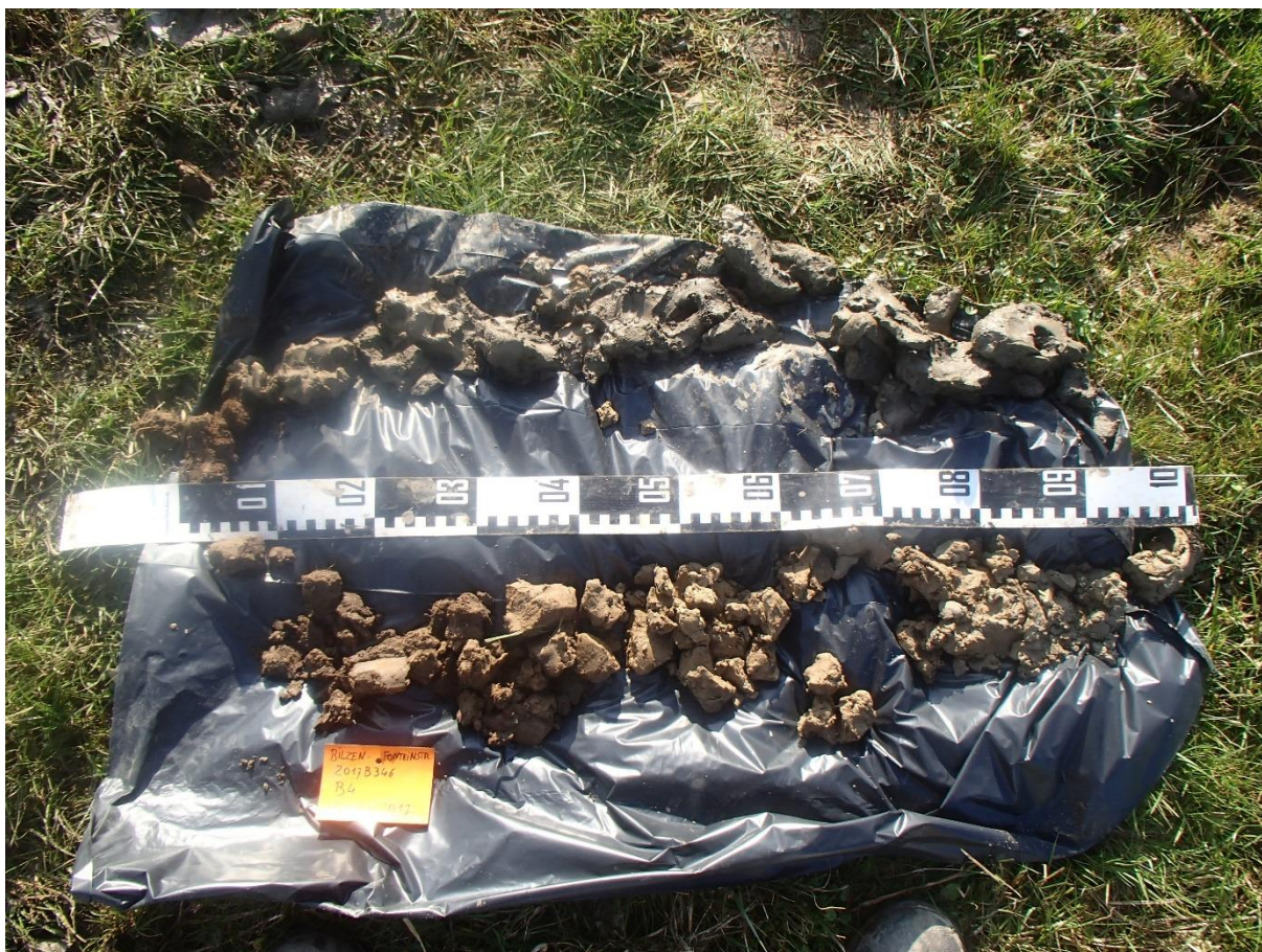
Figuur 45: Boring 4 van 0 (linksonder) tot 200 cm (rechtsboven) beneden maaiveld (Foto door N. Krekelbergh, 23-03-2017)
