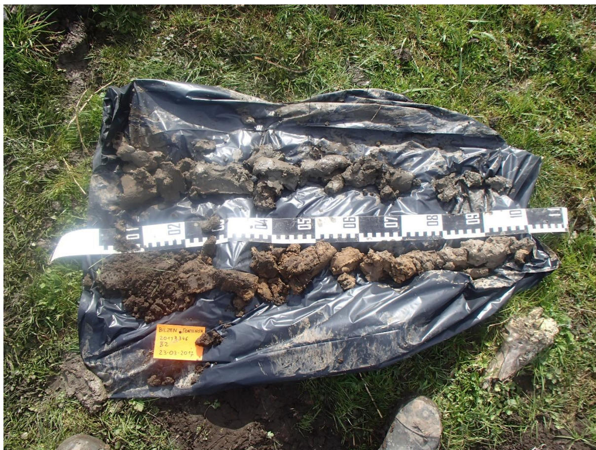
Figuur 43: Boring 2 van 0 (linksonder) tot 200 cm (rechtsboven) beneden maaiveld (Foto door N. Krekelbergh, 23-03-2017)
