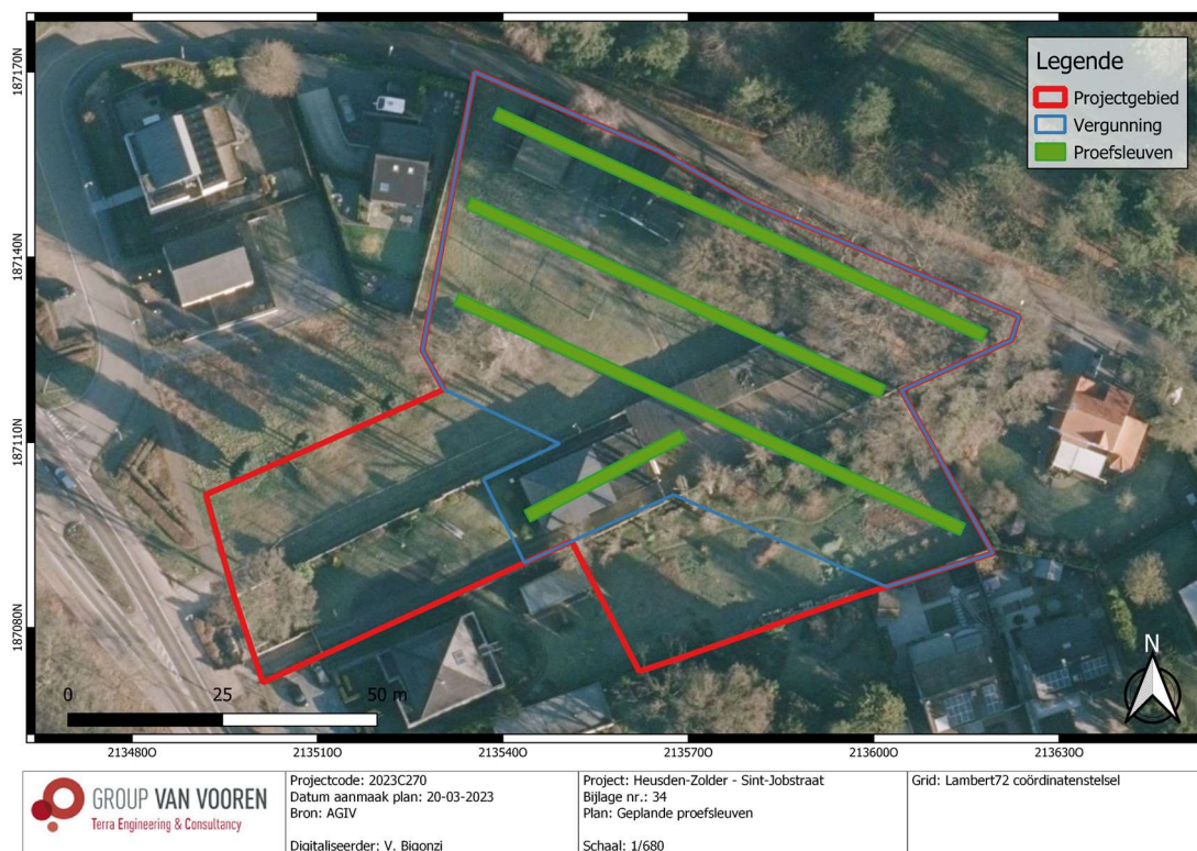
Fig. 3.4: Voorstel inplanting proefsleuven (© Bigonzi et al. 2023, fig. 2.7; AGIV).
