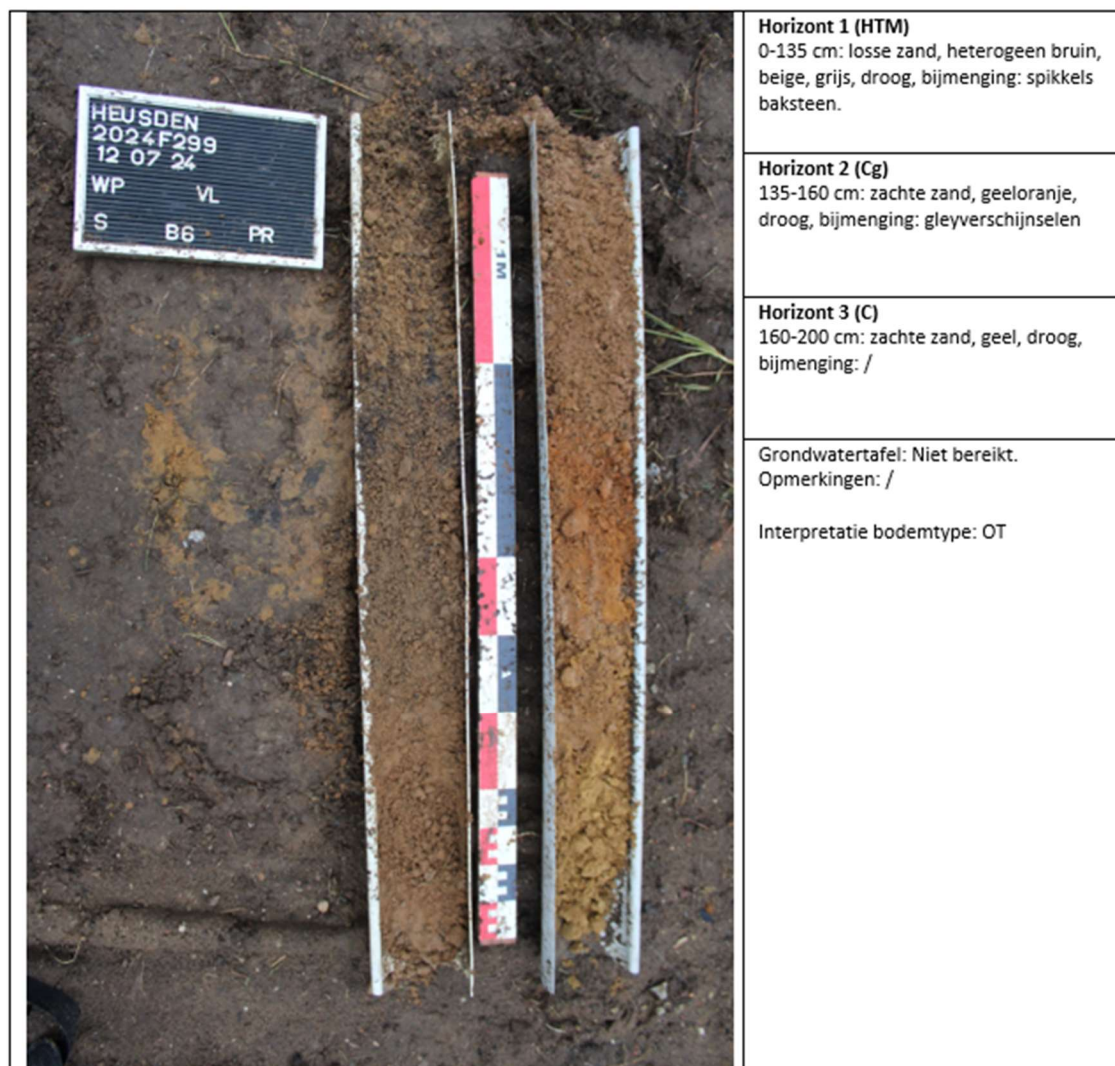
Fig. 2.12: Bodemprofiel 6, referentiebodemprofiel pedogenetische zone met verstoringen.
