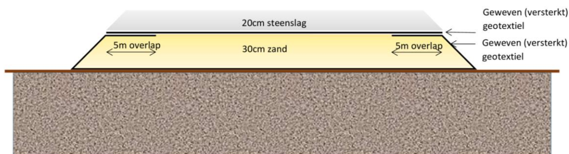
Figuur 29: schematische weergave van de opbouw van het terrein voor grondverbetering. (Initiatiefnemer 2024)
