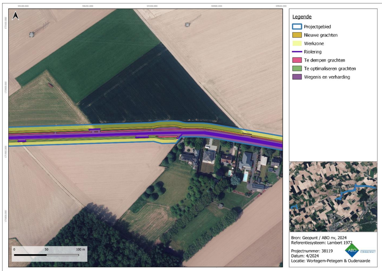
Figuur 20: Overzicht van de geplande bodemingrepen ter hoogte van het oostelijk lijntracé per niveau op ortholuchtfoto - deel 4.
