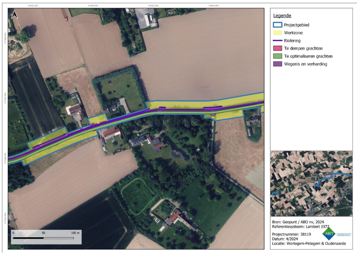
Figuur 18: Overzicht van de geplande bodemingrepen ter hoogte van het oostelijk lijntracé per niveau op ortholuchtfoto - deel 2.
