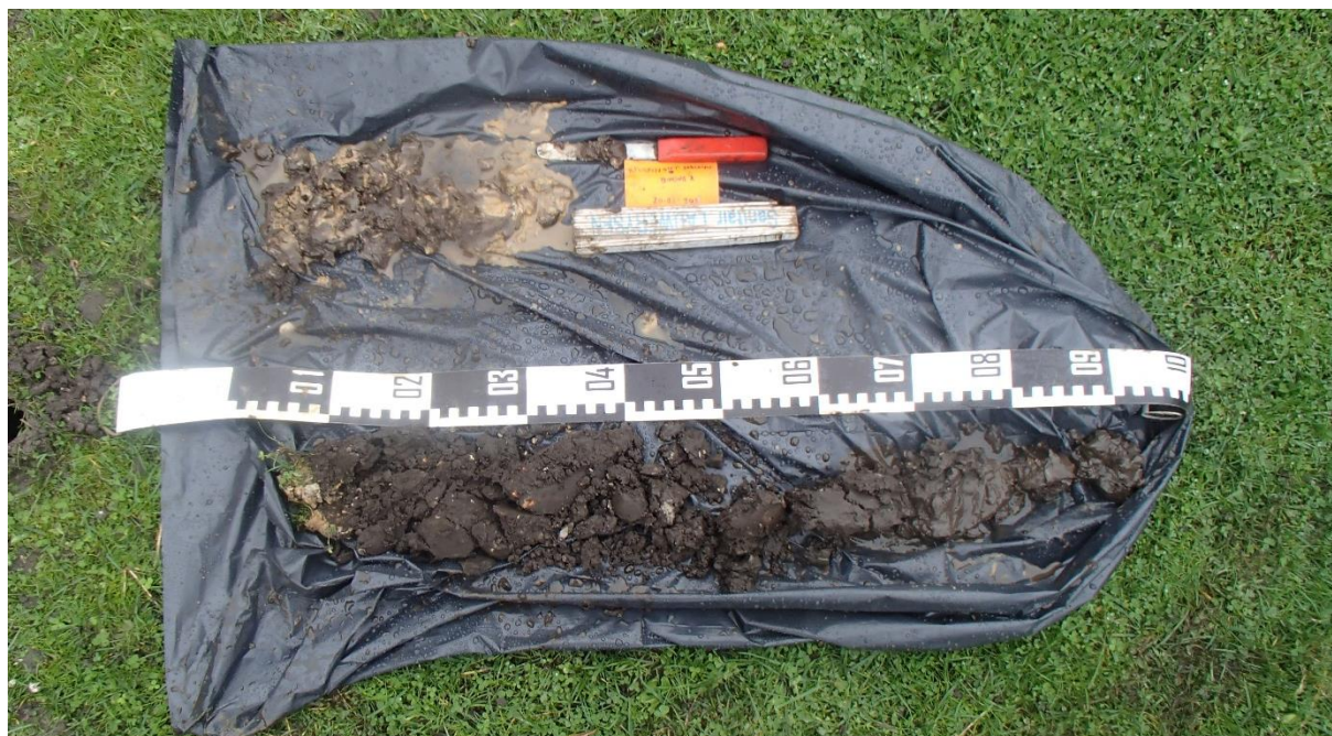
Figuur 51: Boring 2 van 0 (linksonder) tot 150 cm (rechtsboven) beneden maaiveld (Foto door N. Krekelbergh, 20-03-2017).
