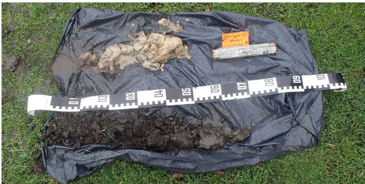
Figuur 52: Boring 3 van 0 (linksonder) tot 150 cm (rechtsboven) beneden maaiveld (Foto door N. Krekelbergh, 20-03-2017).
