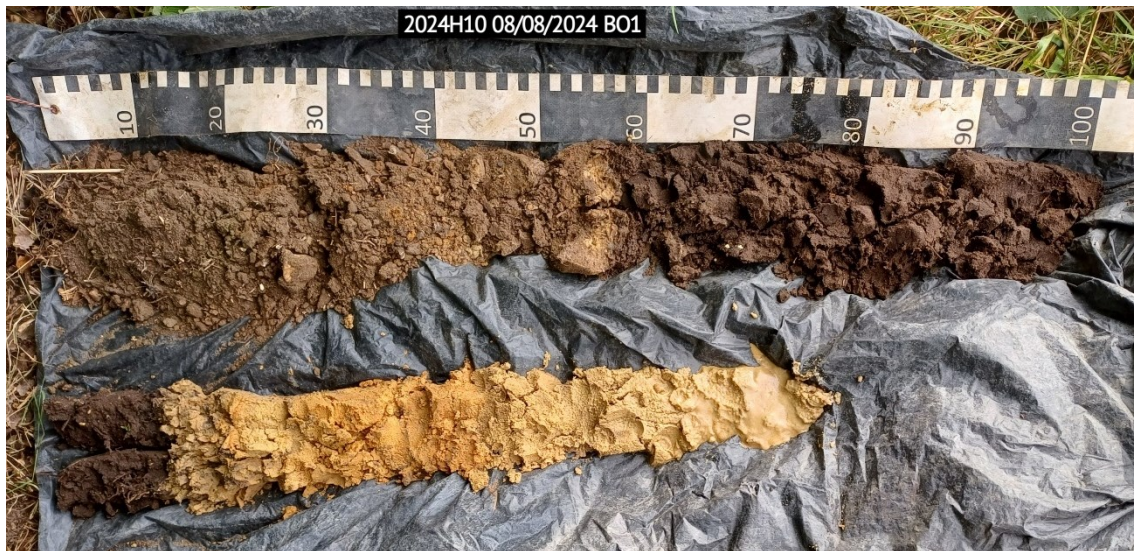
Figuur 20: Boorprofiel 1 met de bovenzijde linksboven en de onderzijde rechtsonder
