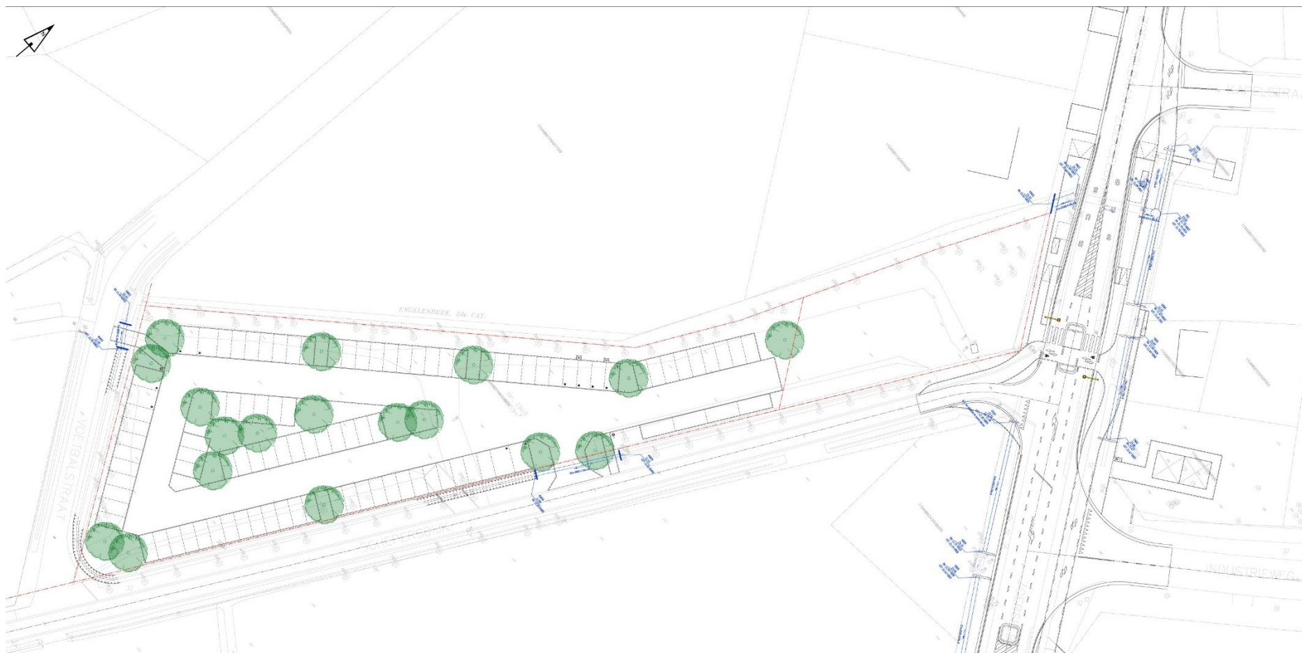
Figuur 7: Rioleringsplan ontworpen toestand (deel 1)
