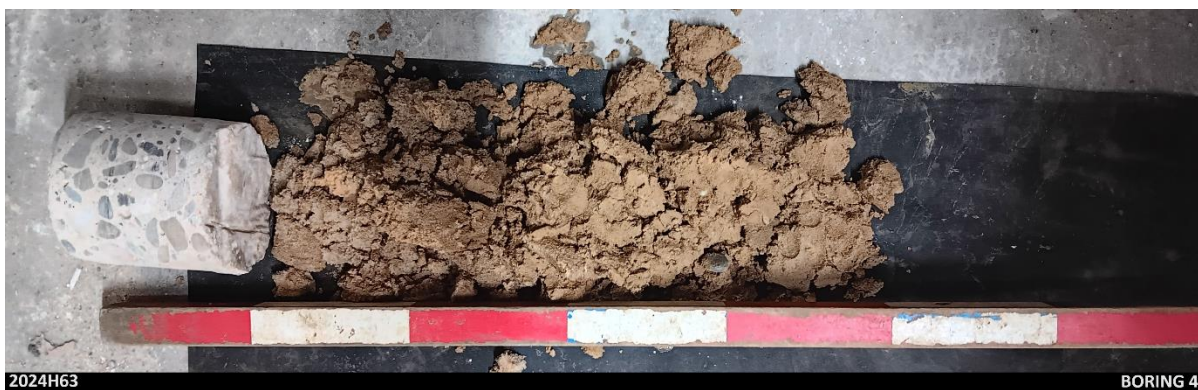
Figuur 8 : boring 4, typeprofiel voor bodem onder de verharding, binnen gebouw.
