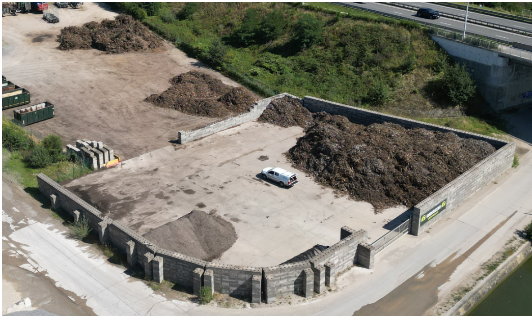
Figuur 7. Opslag van verhakseld hout en schors. Onder: luchtfoto van de openlucht opslag, bemerk ook de duidelijke overgang in de verharding.
