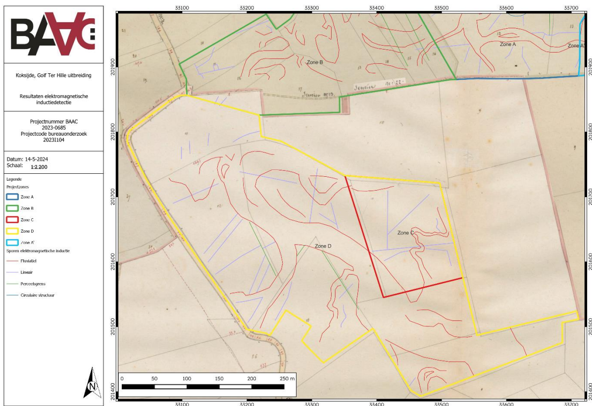
Plan 43: Resultaten van de elektromagnetische inductiedetectie op de Atlas der Buurtwegen (analoog; 1:2500; 14.05.2024)
