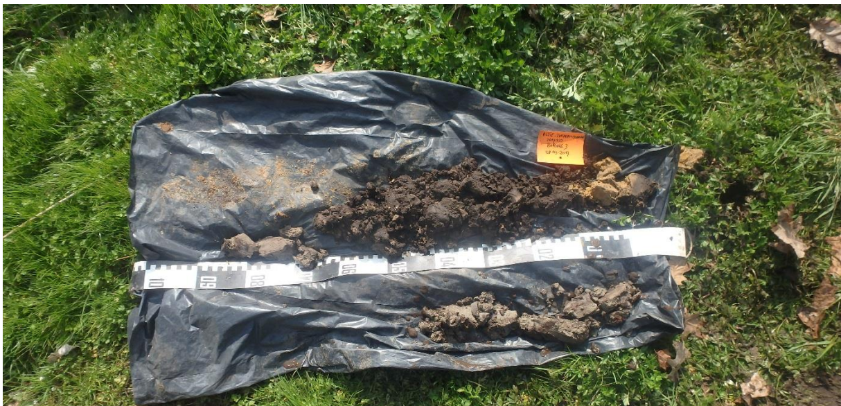
Figuur 29: Boring 3 van 0 (linksboven) tot 150 cm (rechtsonder) beneden maaiveld (Foto door N. Krekelbergh, 28-03-2017)
