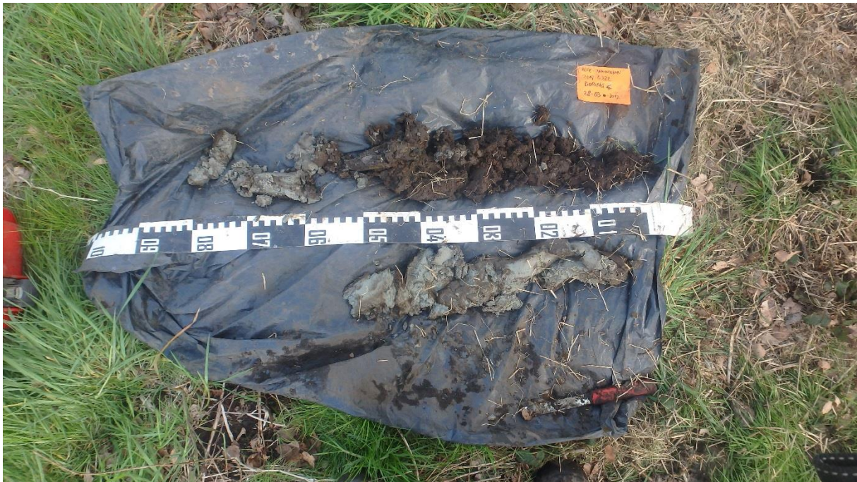
Figuur 30: Boring 4 van 0 (linksboven) tot 150 cm (rechtsonder) beneden maaiveld (Foto door N. Krekelbergh, 28-03-2017)
