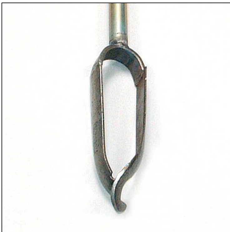
Figuur 19: Combiboor met een diameter van 7 cm (Bron: http://www.eijkelkamp.com )
