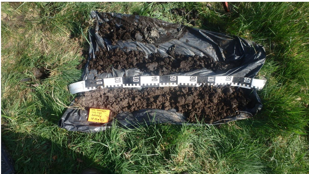
Figuur 32: Boring 6 van 0 (rechtsonder) tot 250 cm (linksboven) beneden maaiveld (Foto door N. Krekelbergh, 28-03-2017)
