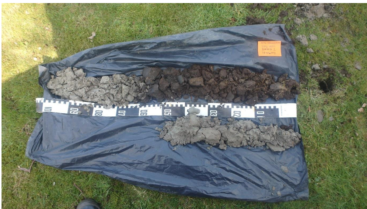
Figuur 27: Boring 1 van 0 (linksboven) tot 150 cm (rechtsonder) beneden maaiveld (Foto door N.Krekelbergh, 28-03-2017)
