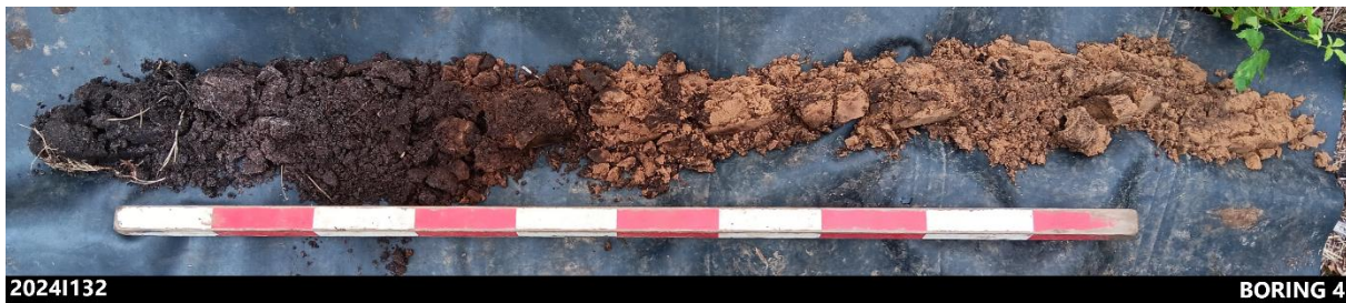
Figuur 10: Boring 4, typeprofiel voor profieltype 5.
