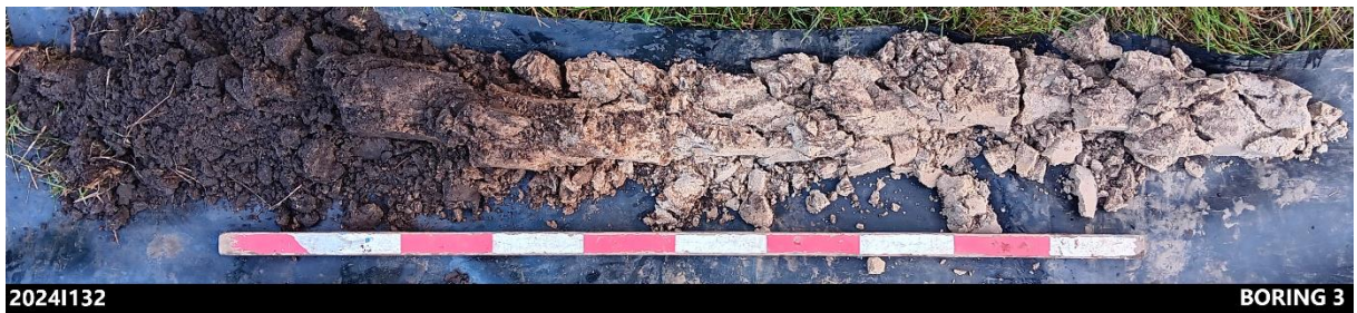
Figuur 7: Boring 3, typeprofiel voor profieltype 2.
