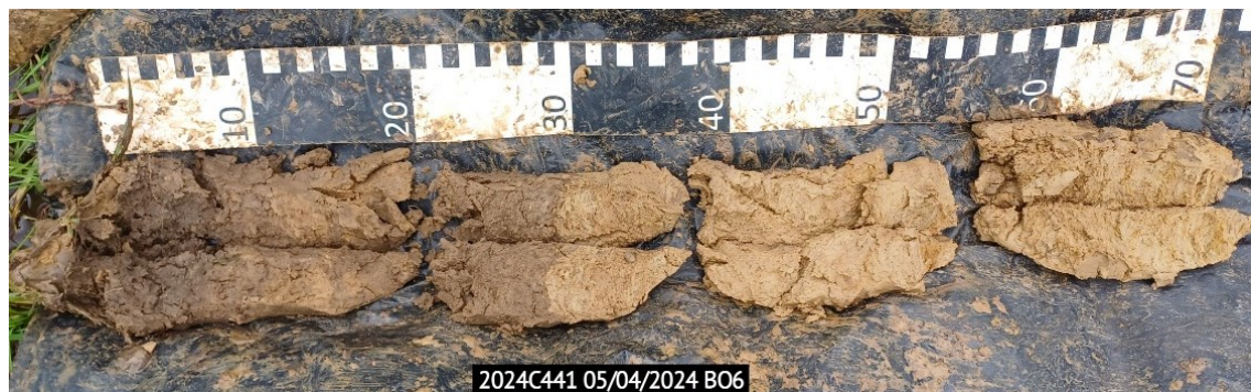
Figuur 19: Boorprofiel 6 met de bovenzijde links en de onderzijde rechts
