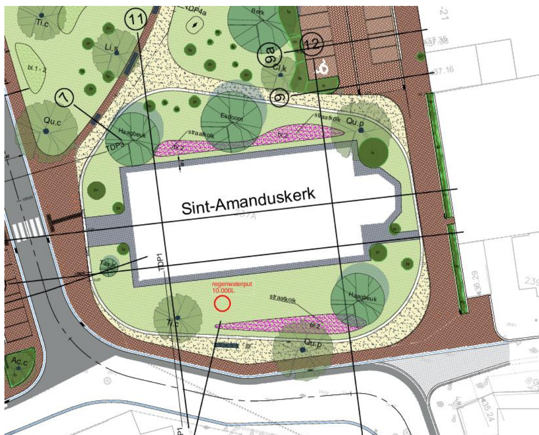
Figuur 4: Inplantingsplan met weergave van de geplande regenwaterput 5
