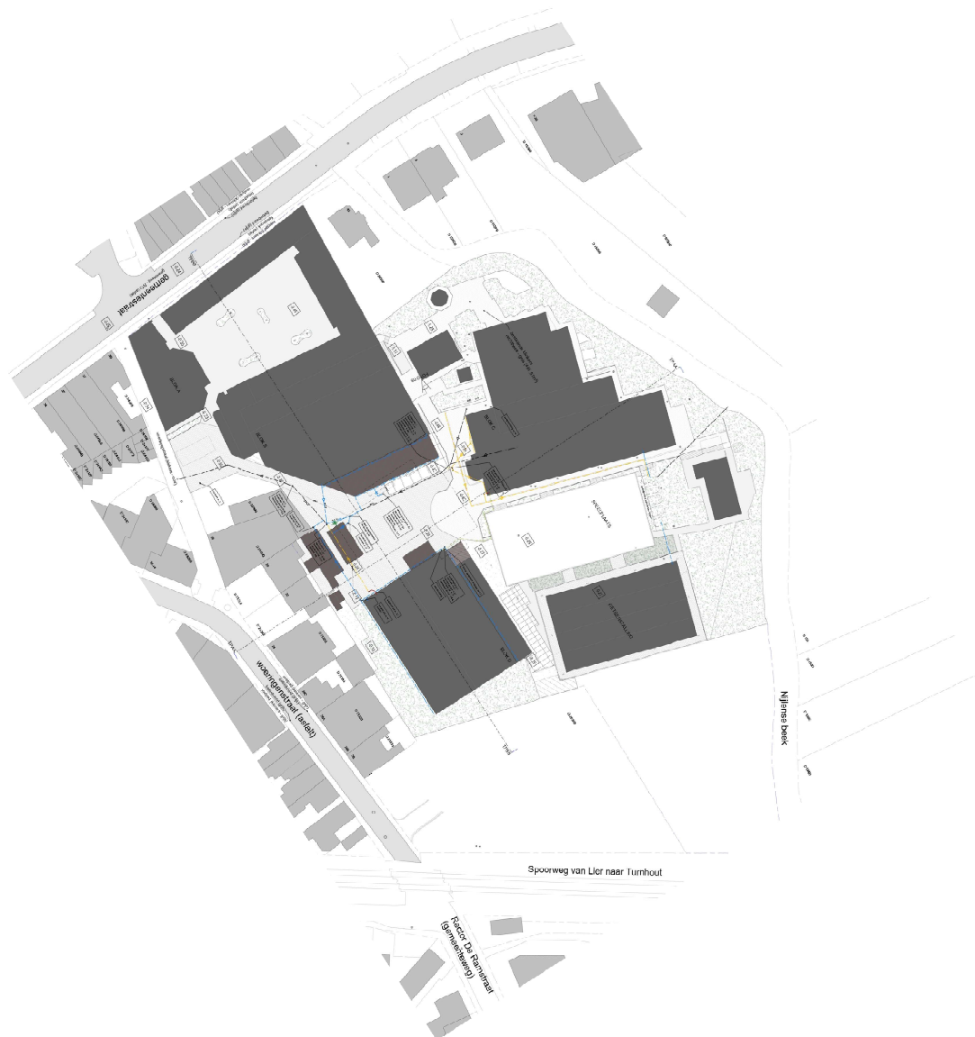
Afbeelding 3.7.4: Bestaande toestand nutsleidingen (bron: aangesteld architectenbureau).
