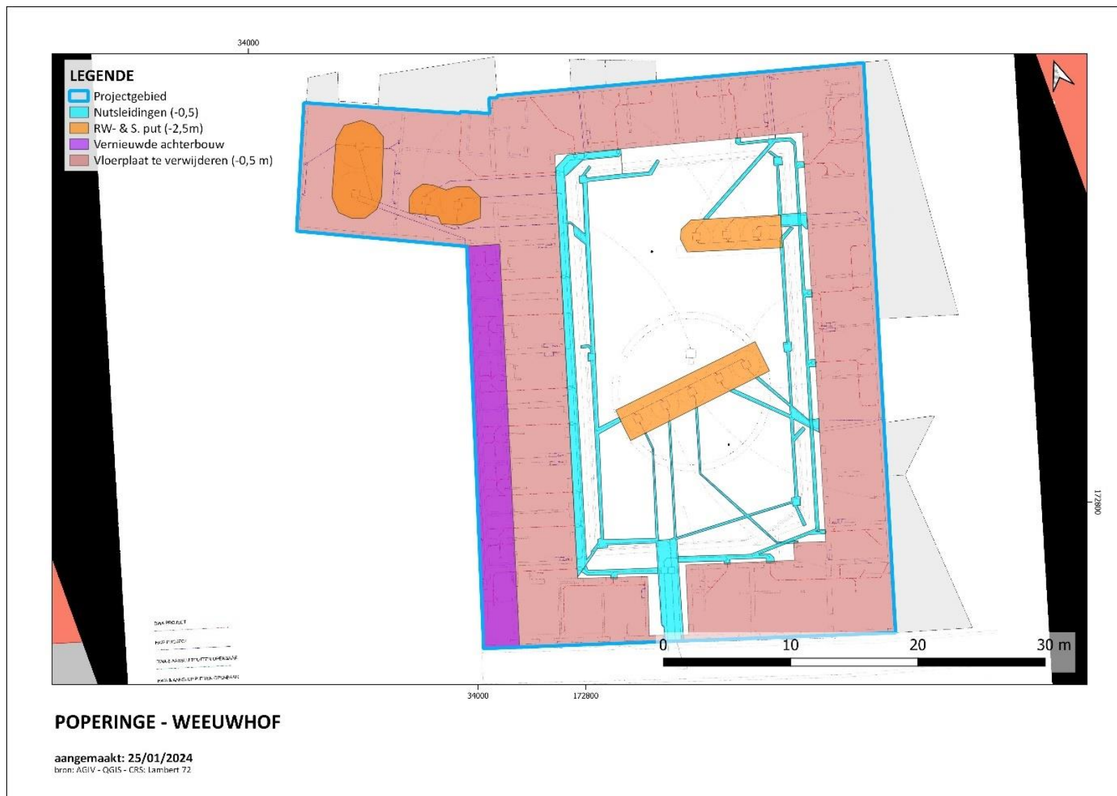
Figuur 6. Geplande werken met de bijhorende, verwachte verstoringsdiepte. Hierbij moet telkens nog een buffer van 30 cm worden gerekend, weergegeven op de geplande nutsleidingen.
