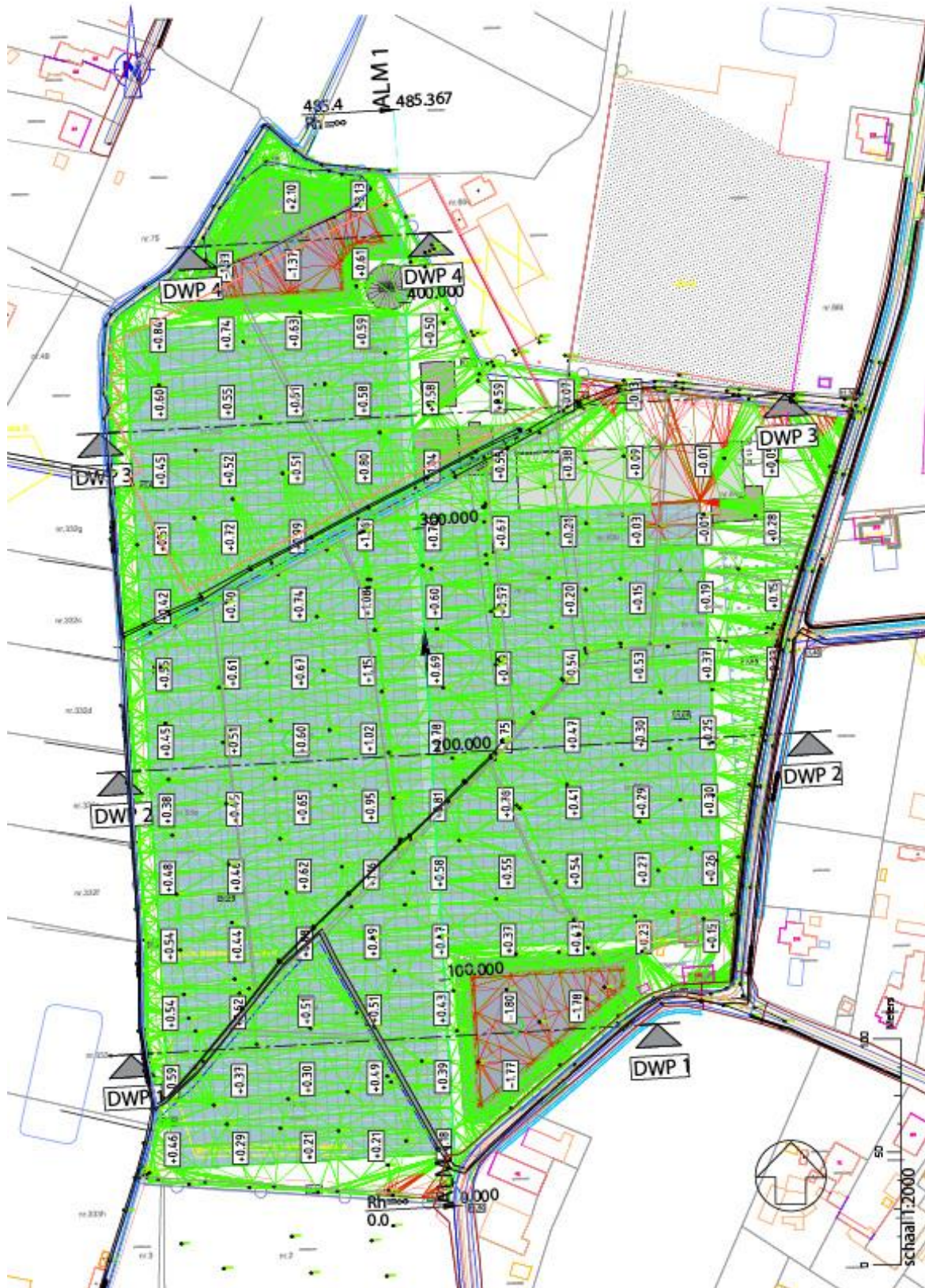
Figuur 1.1-6 Definitief plan geplande werkzaamheden. Overzicht ligging dwarsprofielen 1 t.e.m 4. Groen=gronden ophogen, Rood=gronden afgraven (© Looije Agro Technics).
