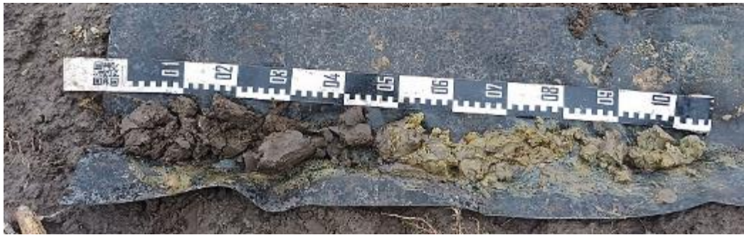
Figuur 13 : Boring 6 van 0 (links) naar 100 cm (rechts) beneden het maaiveld
