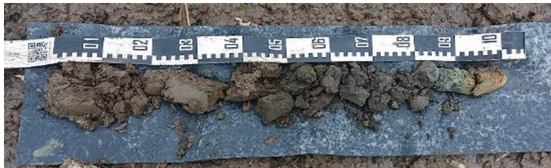
Figuur 12 : Boring 5, van 0 (links) naar 100 cm (rechts) beneden het maaiveld
