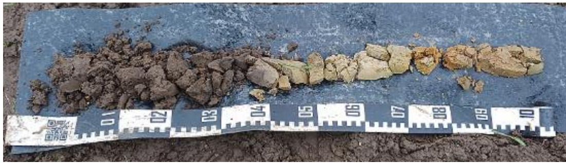
Figuur 11 : Boring 4, van 0 (links) naar 100 cm (rechts) beneden het maaiveld
