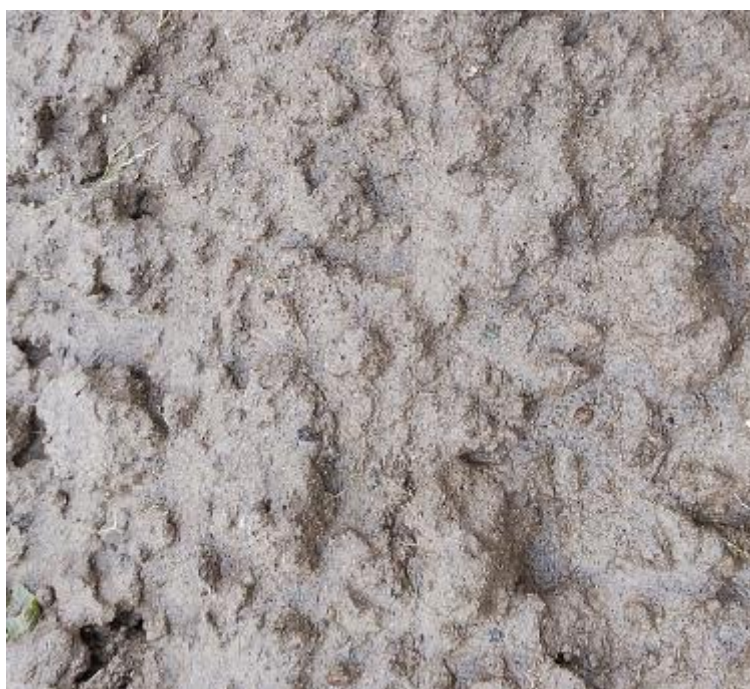
Figuur 7: Duidelijk zichtbare glauconietspikkels aan het oppervlak ter hoogte van boring 5.
