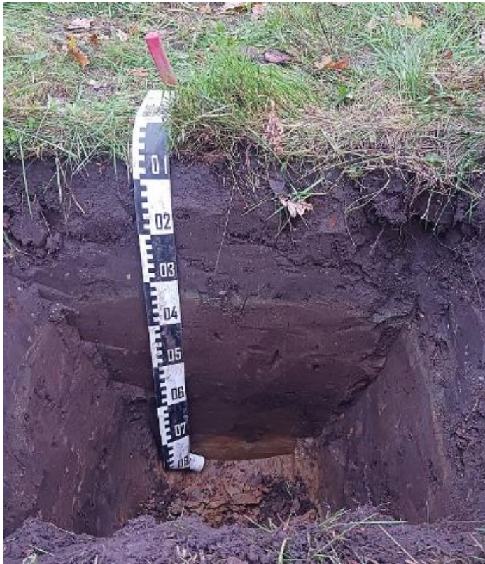
Figuur 8: Profielpuut 1. Met rechts een detailopname van de bodem van de profielpuut, met de overgang van AC/ naar C-horizont.
