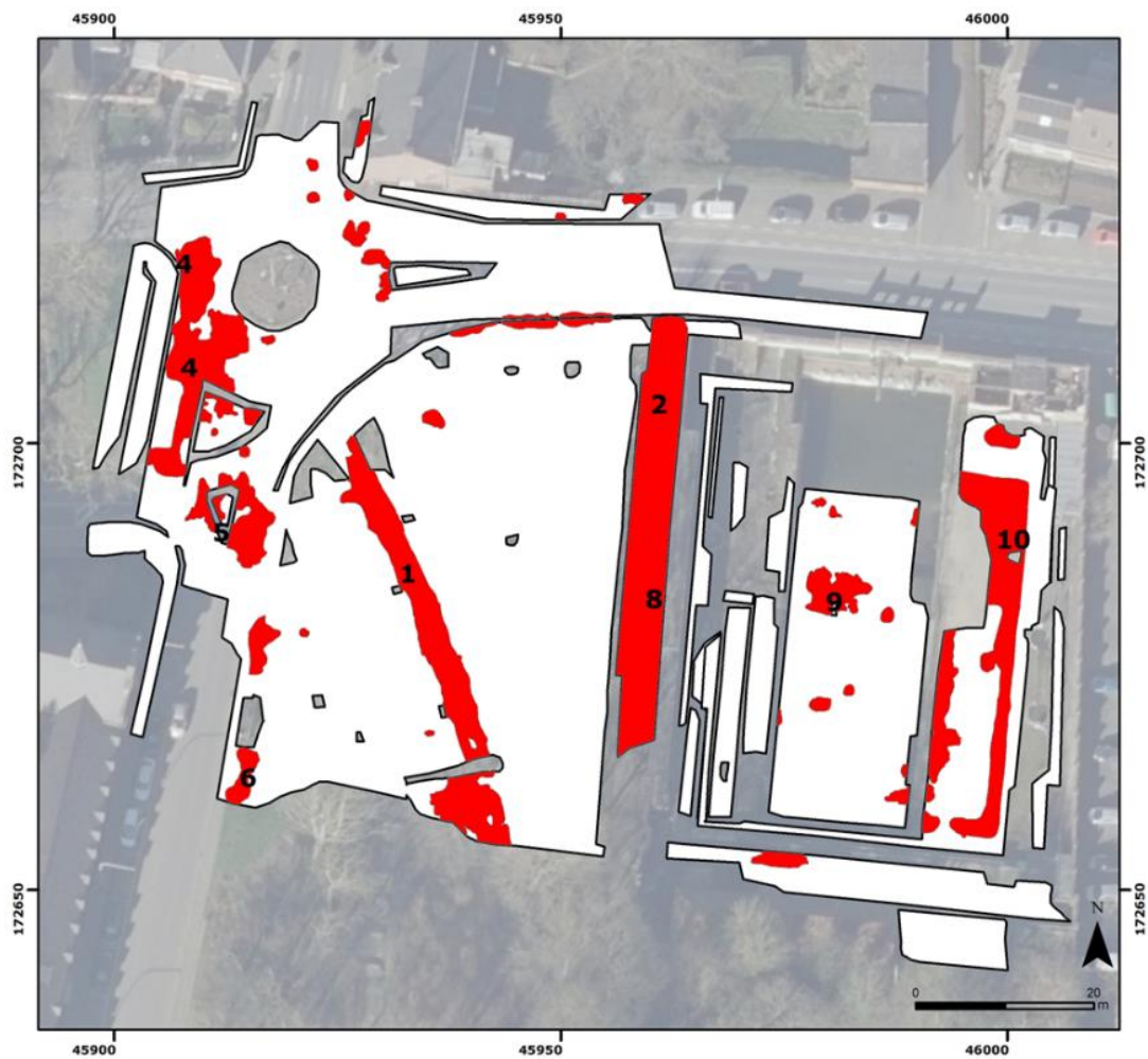
Figuur 36: synthesesfiguur uit het rapport van 3Dsoil met aanduiding van de meeste prominente GPR-reflecties, waar dus heterogeniteiten in opbouw (massieven, funderingen, wapening, holtes) verwacht worden.
