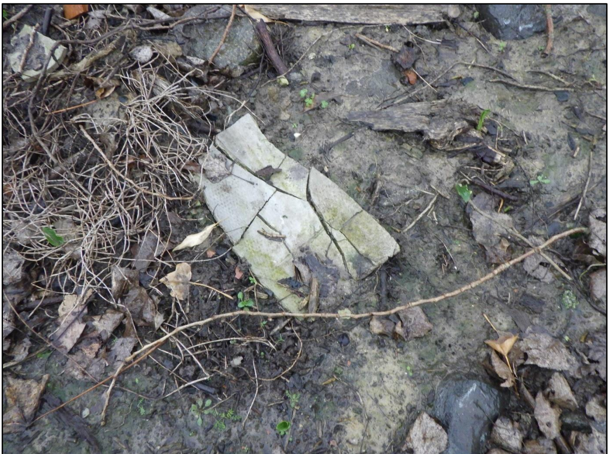
Figuur 1 Asbest aangetroffen in het zuidoostelijk deel van het projectgebied.
