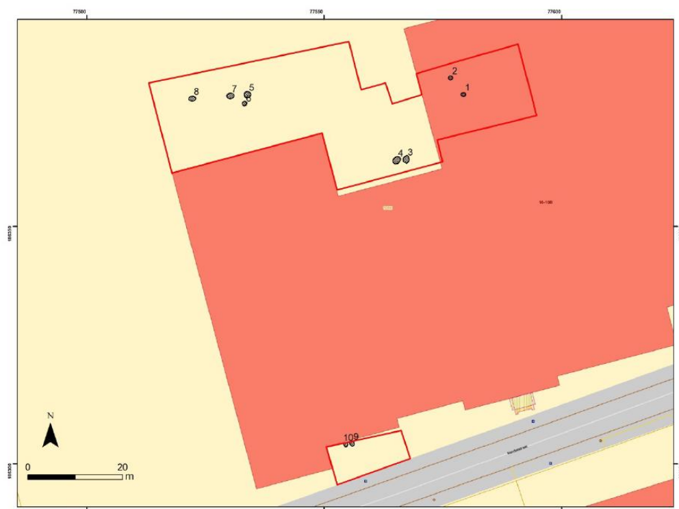
Figuur 23: Aanduiding van de gedetecteerde anomalieën die mogelijk holtes of volumes vloeistof en dus tanks kunnen voorstellen in de gescande zones (rood) (bron: initiatiefnemer)
