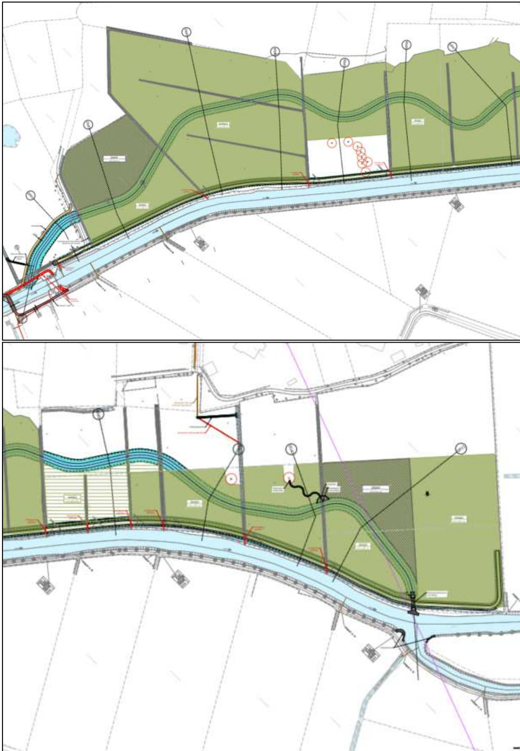
Figuur 2: Uitsnede van het inplantingsplan; met de huidige waterloop Mark (lichtblauw), de nieuwe meander (donkerblauw), de af te graven en op te hogen percelen (groen). Het noorden is rechts boven. 4
