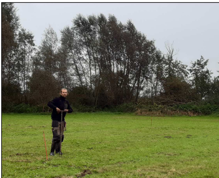
Figuur 11: Foto methodiek. De boringen werden handmatig uitgevoerd met een Edelman 7 cm boor en daarnaast werd voor de kleiige en venige pakketten gebruik gemaakt van een guts.
