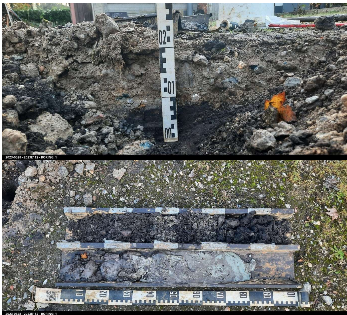
Figuur 10 : Boring 1, van 0 (rechtsboven) naar 180 cm (linksonder) beneden het maaiveld
