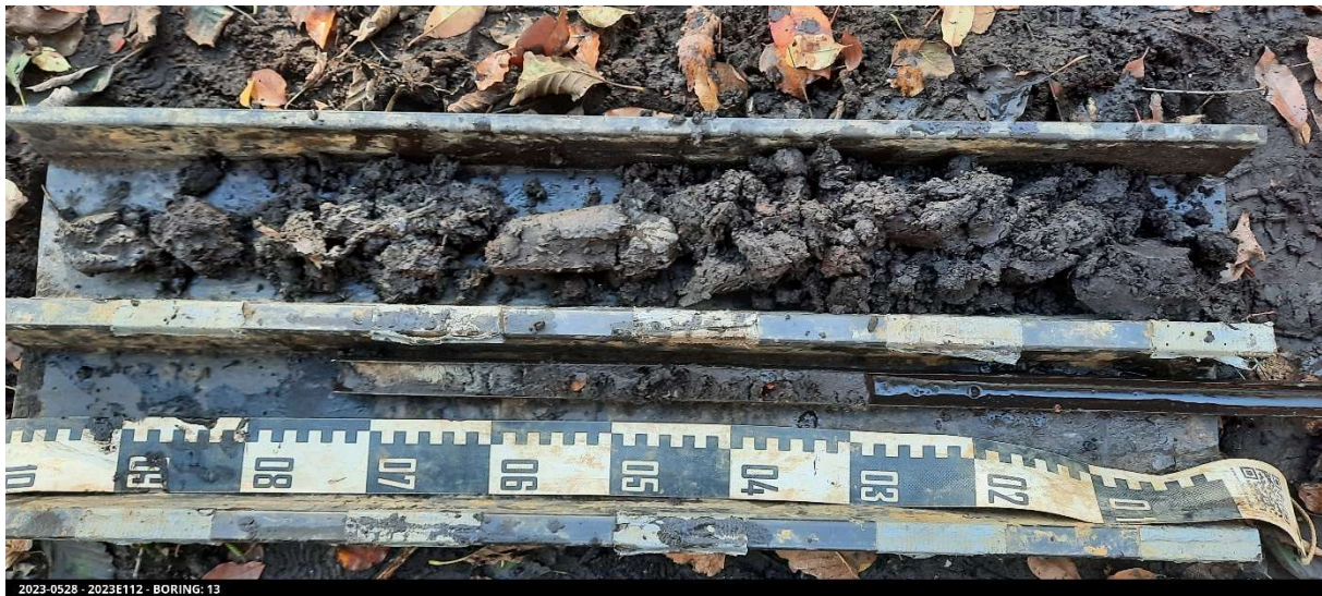
Figuur 12 : Boring 13, van 0 (rechtsboven) naar 175 cm (linksonder) beneden het maaiveld
