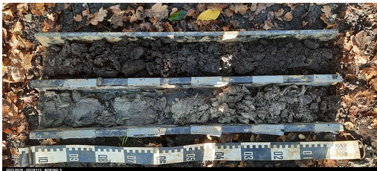
Figuur 11 : Boring 5, van 0 (rechtsboven) naar 200 cm (linksonder) beneden het maaiveld
