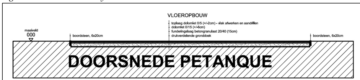
Figuur 9. Doorsnede petanquebaan.
