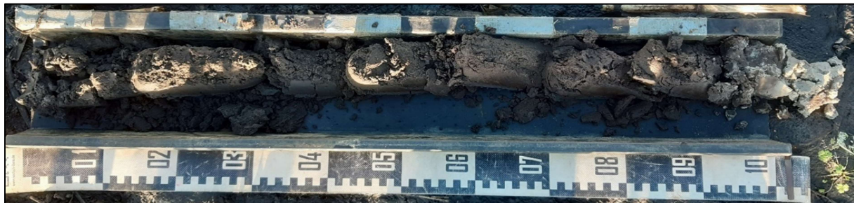
Figuur 8 : Boring LB3, van 0 (links) naar 110 cm (rechts) beneden het maaiveld
