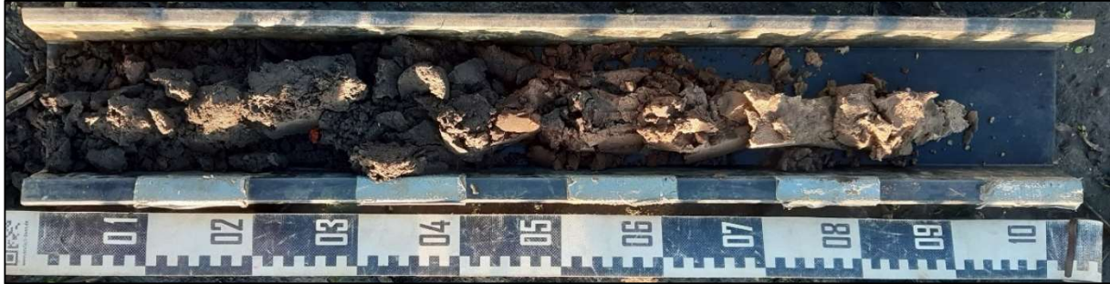
Figuur 7 : Boring LB2, van 0 (links) naar 90 cm (rechts) beneden het maaiveld
