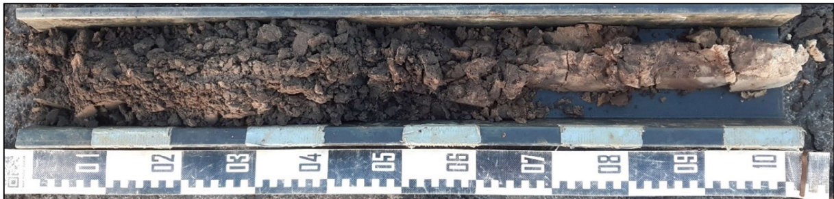
Figuur 6 : Boring LB1, van 0 (links) naar 100 cm (rechts) beneden het maaiveld
