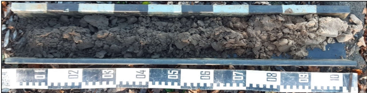
Figuur 9 : Boring LB4, van 0 (links) naar 100 cm (rechts) beneden het maaiveld
