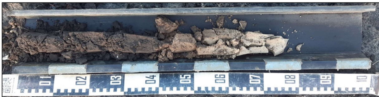
Figuur 10 : Boring LB5, van 0 (links) naar 75 cm (rechts) beneden het maaiveld
