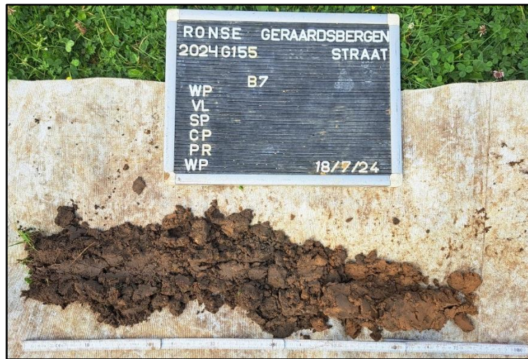
Figuur 14: Boring 7 (A-AC-C)
