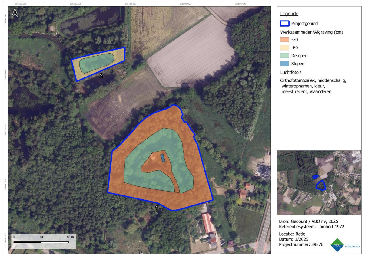
Figuur 10: Overzicht van de geplande bodemingrepen. De dieptes van de afgravingen zijn maximale waarden en zullen op veel plaatsen minder diep gaan.
