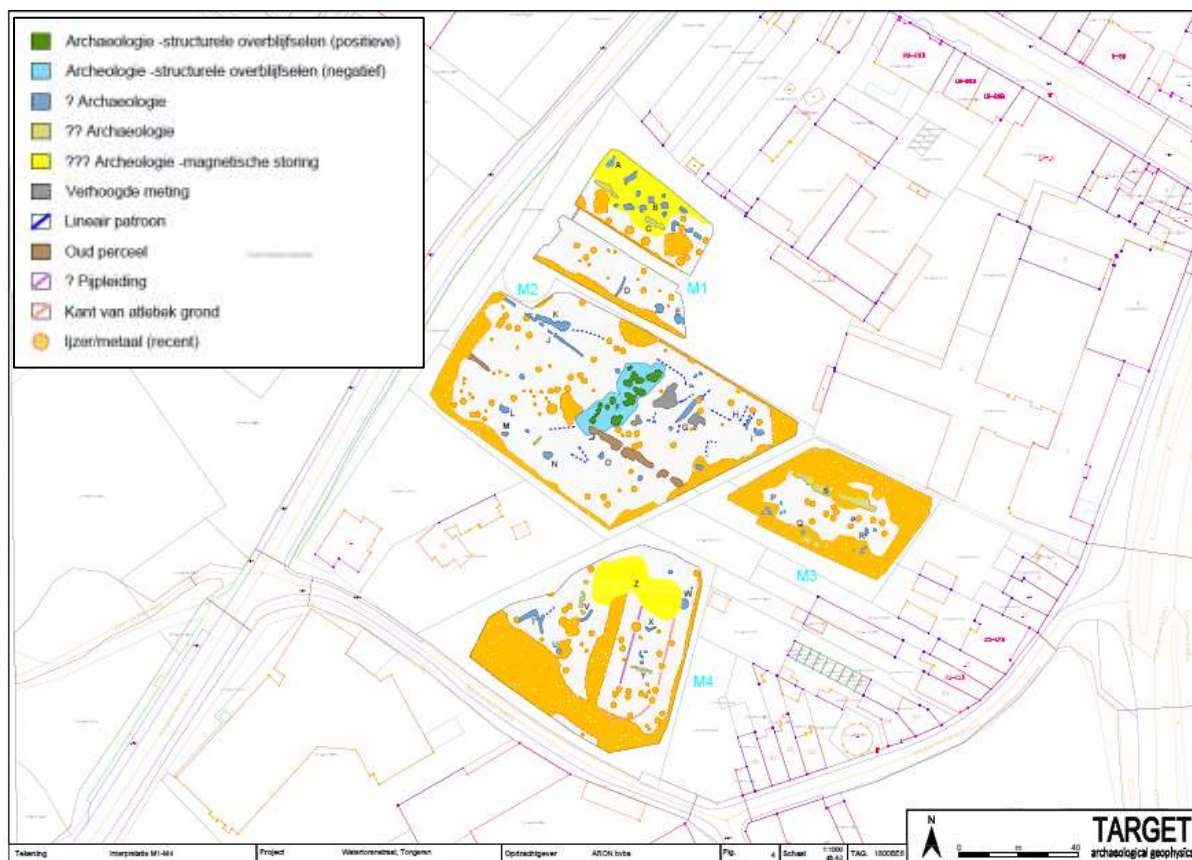
Afb. 5: Overzichtsplan met interpretatie van de resultaten van het magnetometrisch onderzoek. Groen: archeologie – positieve structurele overblijfselen, lichtblauw: archeologie – negatieve structurele overblijfselen, donkerblauw en lichtgroen: archeologie (?), ??), geel: archeologie??? – magnetische verstoring, donkerblauwe lijn: lineair patroon, bruin: oud perceel, paars: ?pijpleiding, oranje lijn: kant van atletiek grond, oranje gevlekt en rood omlijnd: ijzer/metaal (recent)) (Bron: Target Archaeological Geophysics, digitaal plan, dd onbekend, aanmaatschaal 1:1000).
