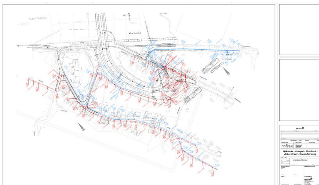
Afbeelding 2: rioleringsplan met de DWA in het rood en de RWA in het blauw.
