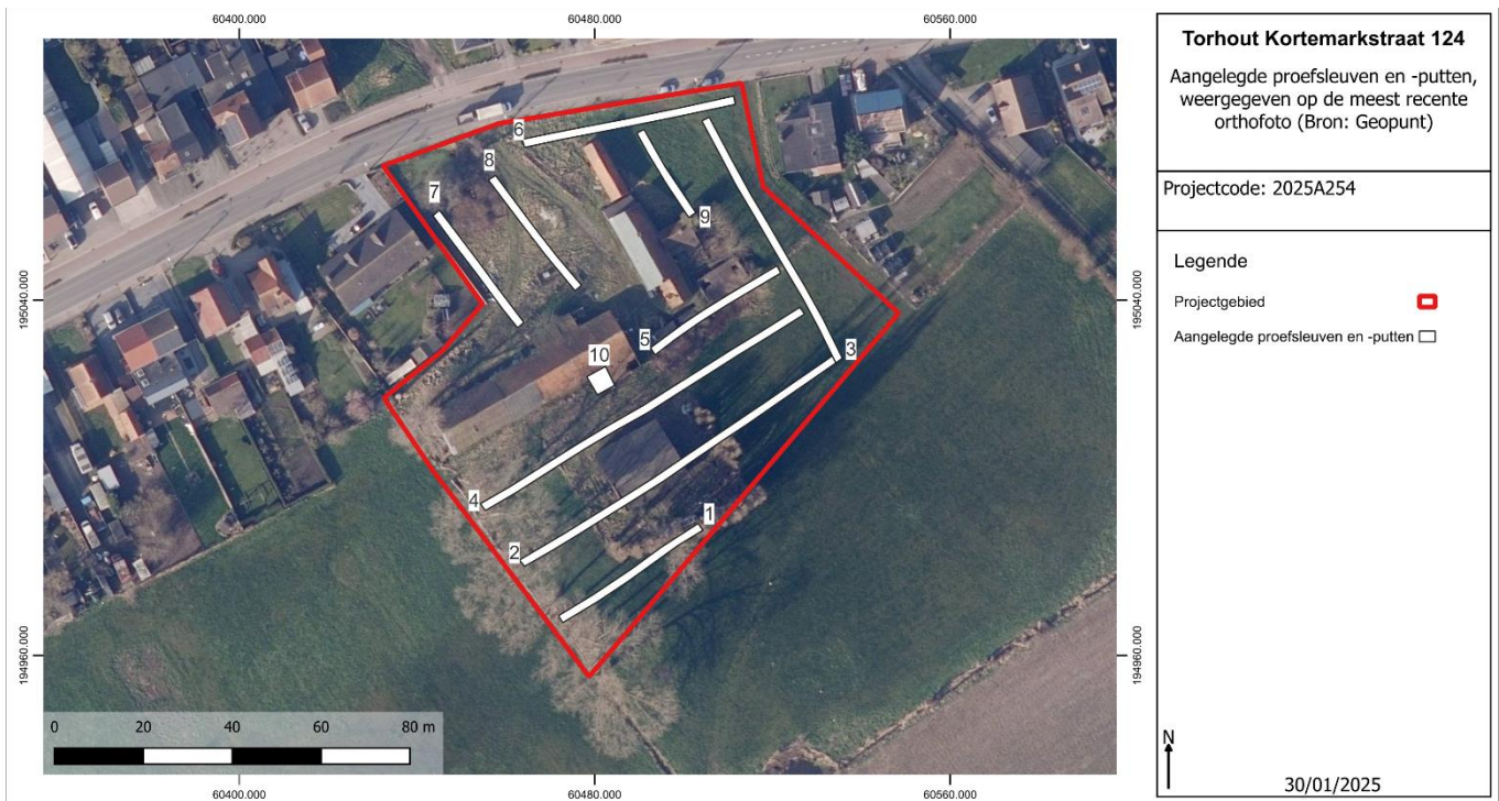
Figuur 12: Aangelegde proefsleuven op de meest recente orthofoto (bron: Geopunt).
