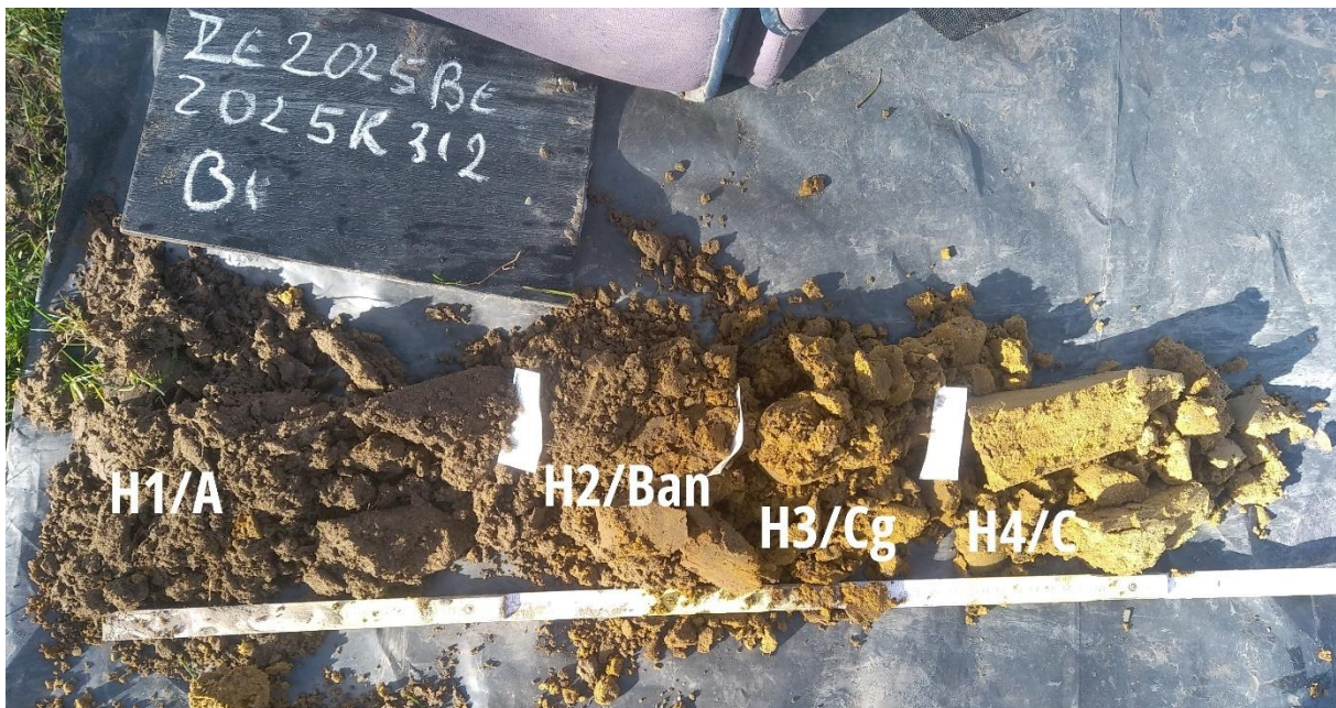
Figuur 14: Boring 1 met aanduiding van de bodemhorizonten
