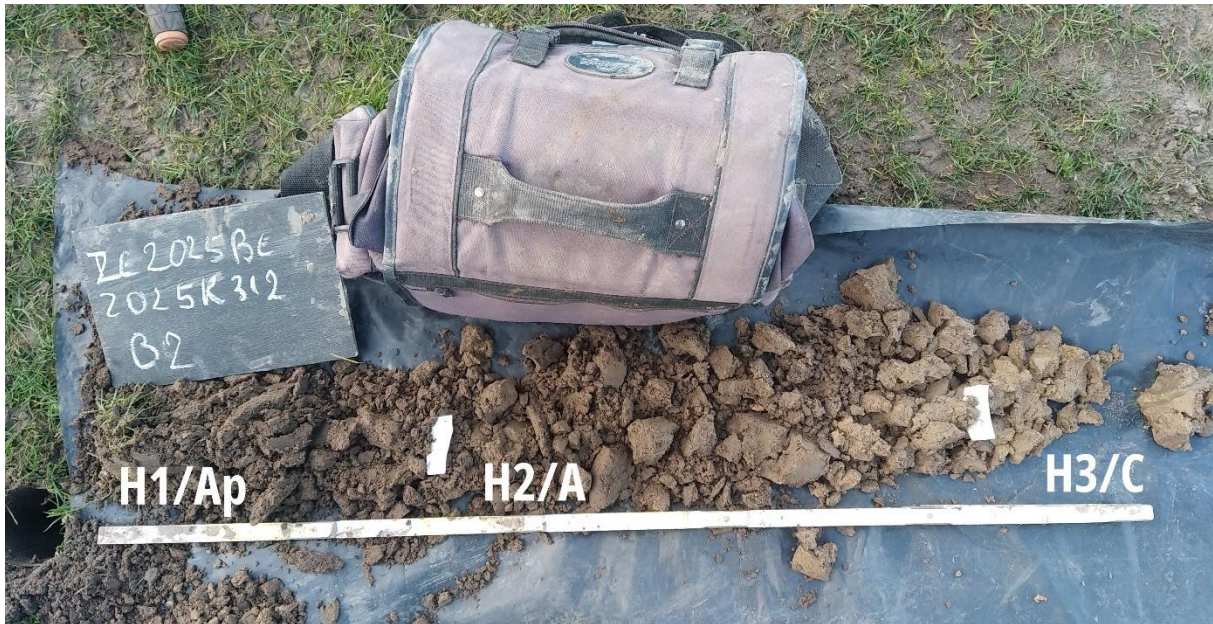
Figuur 15: Boring 2 met aanduiding van de bodemhorizonten
