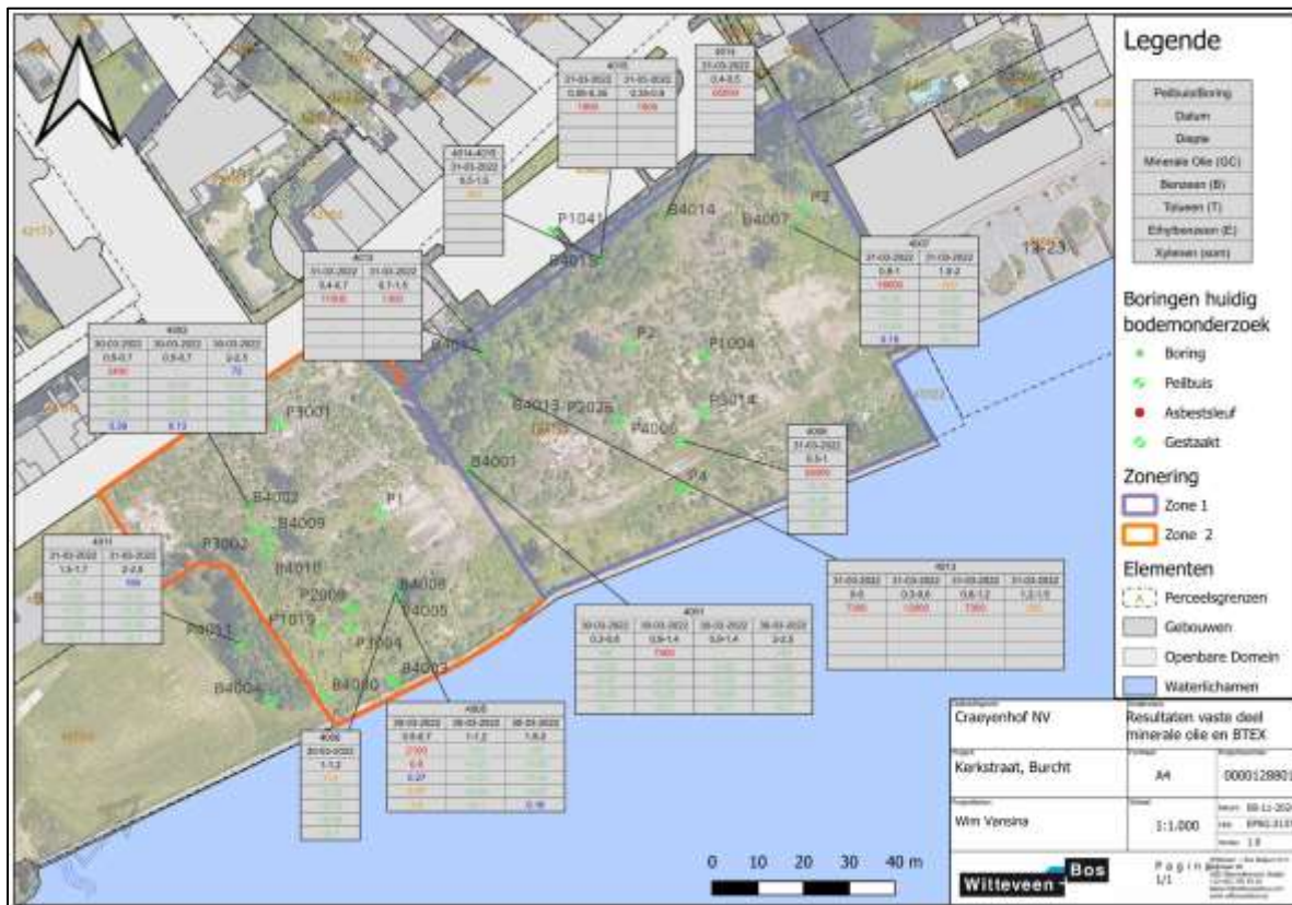
Afb. 24b: Uitgevoerde boringen i.k.v. BSP (Bron: initiatiefnemer, 08/11/2024, 1:1000)
