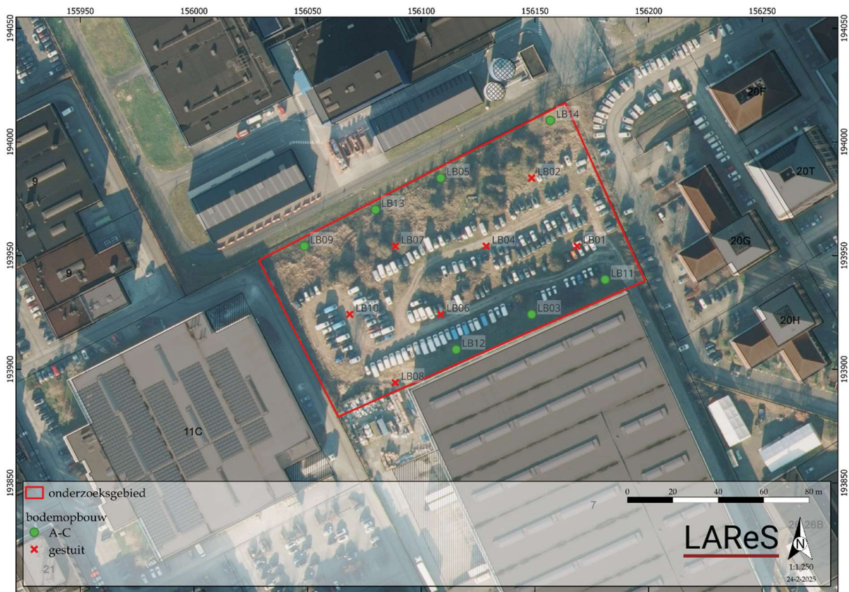
Figuur 11. Uitgevoerde landschappelijke boringen met weergave van de bodemopbouw. 29
