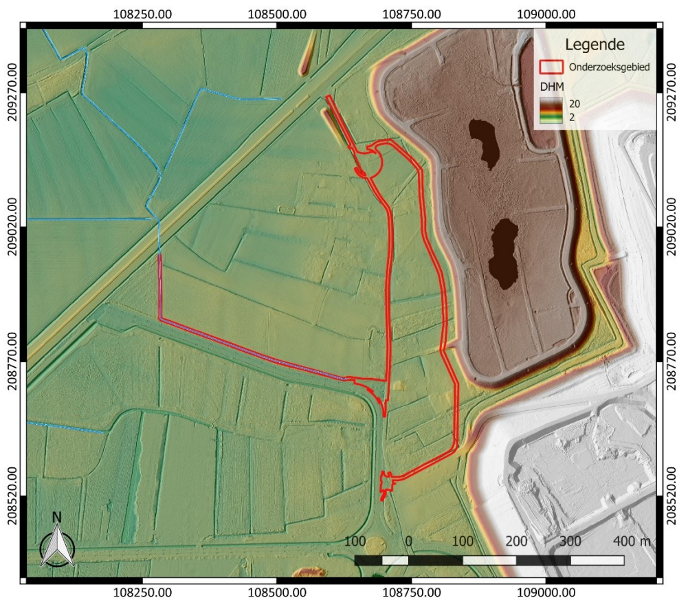
Figuur 8: Digitaal Hoogtemodel Vlaanderen II, DTM 1 m en Multidirectional hillshade DHM Vlaanderen I, 25 cm, met aanduiding van het onderzoeksgebied
