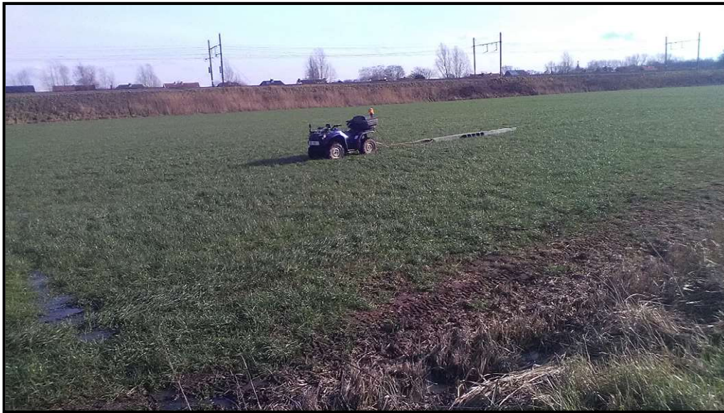
Figuur 6: Mobiele sensorconfiguratie met de EMI sensor in de slede en RTK-GPS.
