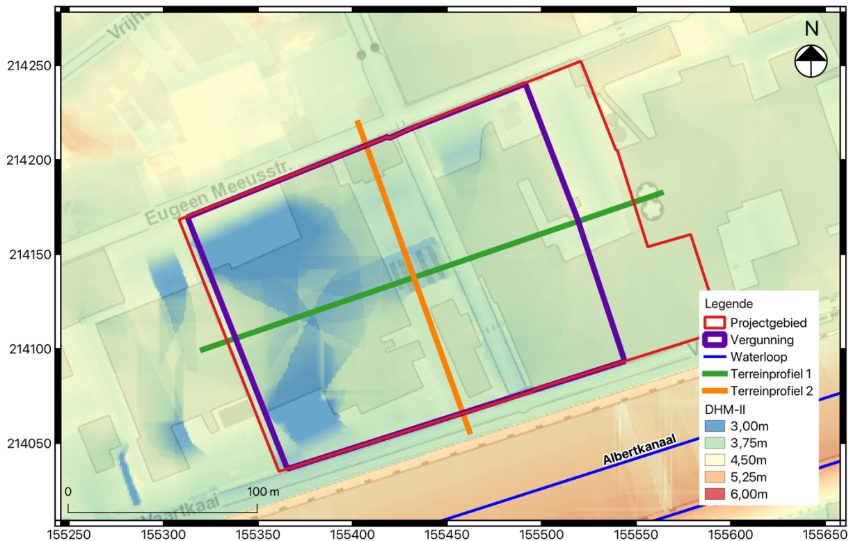
Fig. 1.13: Detail uit het digitaal hoogtemodel (DHM II) met aanduiding van het project- en vergunningsgebied en twee terreinprofielen.
