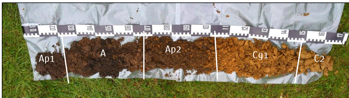
Fig. 7: Foto van boring 1 met aanduiding van de aangetroffen horizonten (Bron: stad Antwerpen, aanmaak 3/05/2017).
