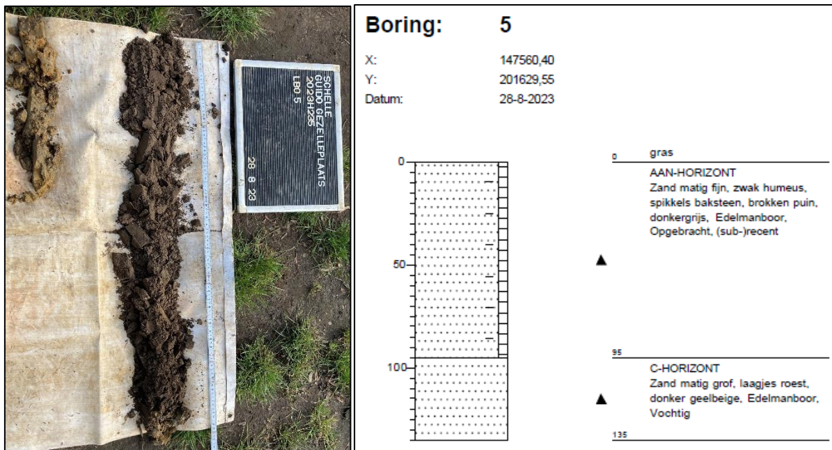
Figuur 10: Boorprofiel (links) en boorbeschrijving (rechts) van boring 5.
