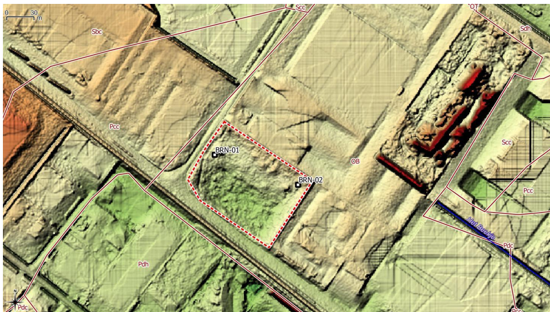
Figuur 10: Bodemkaart van de omgeving van de site Industrierweg in Bornem. De site valt binnen een gebied gekarteerd als OB wat overeenkomt met bebouwde zones (beschaduwd terreinbeeld op basis van Lidar data res. 1 m × 1 m; bron data DOV).
