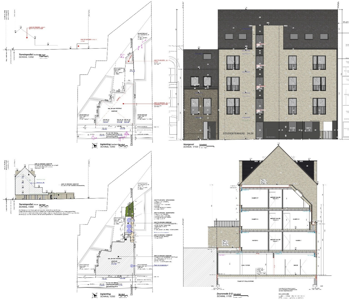
Figuur 3: Bestaande toestand (linksboven), ontworpen toestand (linksonder) en snede (rechtsonder)
