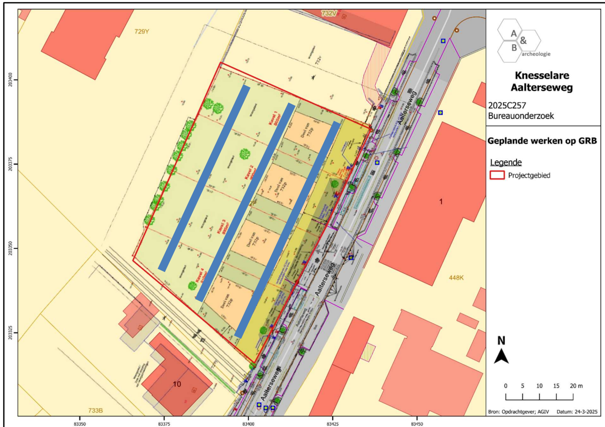
Figuur 2 Indicatief sleuvenplan, geprojecteerd op de geplande werken en het kadasterplan (bron: geopunt.be en initiatiefnemer).
